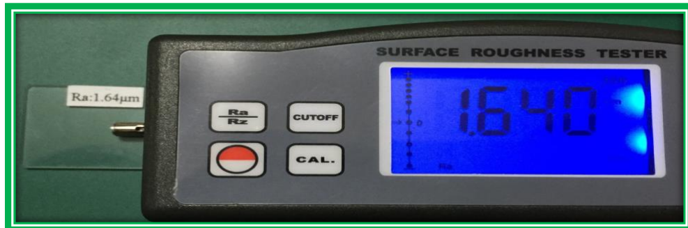
Figura N. 2. Medida de Rugosidad (Ra) obtenida en la pantalla led del Rugosímetro
