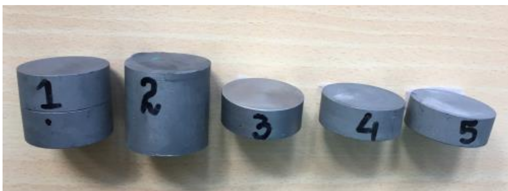
Figura 22: Probetas tras baño de ácido sulfúrico indexadas en la tabla 1
