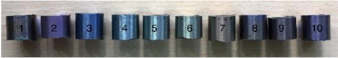
Figura 23: Probetas tras anodizado indexadas en la tabla 2
