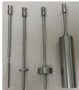
Figura 8. Husos cilíndricos de reómetro Brookfield DV-III Ultra.
