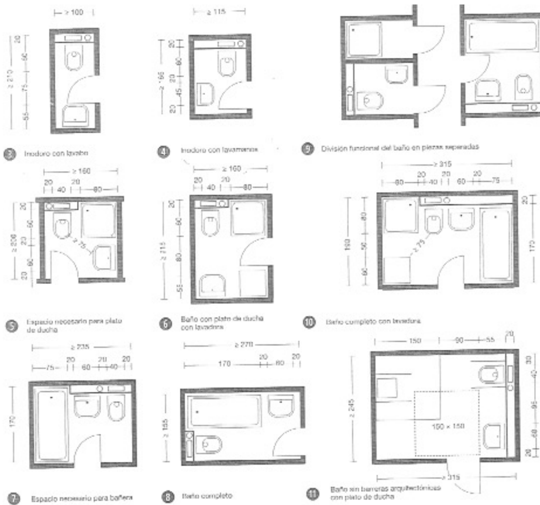
Figura 28. Diagrama distribución y medidas de ejemplos de baños. - NEUFFERT
