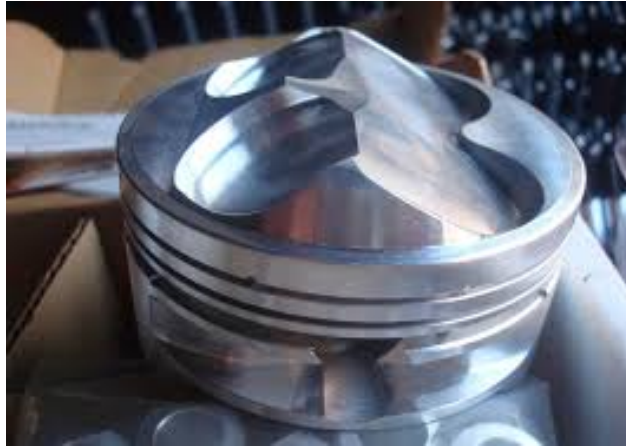
Figura 7. Pistón convexo o de alta compresión
