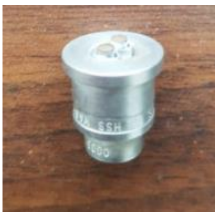
Figura 20: Boquilla con ángulo pulverizador de 0°
