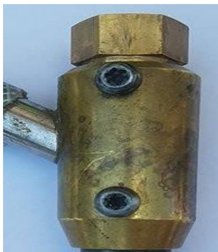
Figura 21: Cámara de mezcla del cabezal de corte
