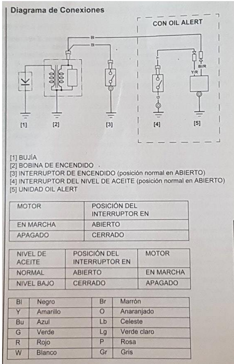
Figura 51: Diagrama de conexiones del motor HONDA GC 190
