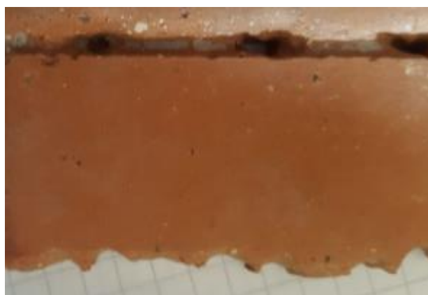
Figura 39: Prueba de corte en pieza de gres porcelánico
