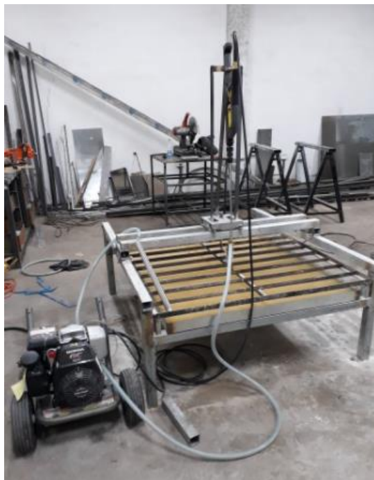
Figura 33: Prototipo de máquina de corte por chorro de agua abrasivo ensamblado
