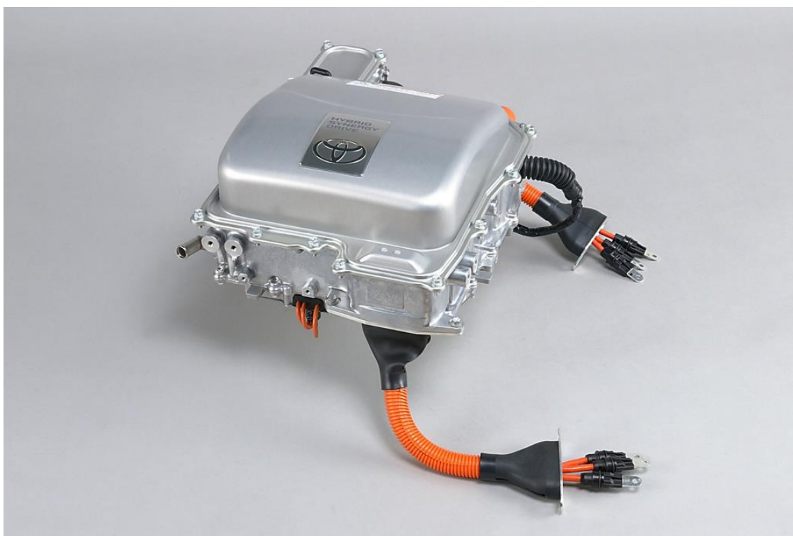
Fotografía 1: Sistema de inversor. - inversor con tapa Fuente: Autor
