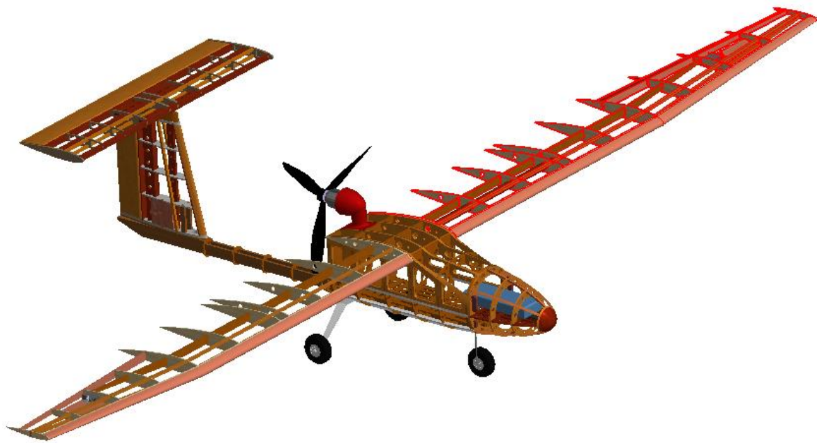
Figura 81 Estructura del primer prototipo en Inventor 2018
