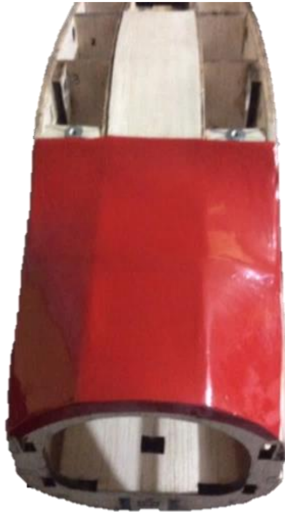
Figura 71 Proceso de aplicación del monokote sobre el fuselaje
