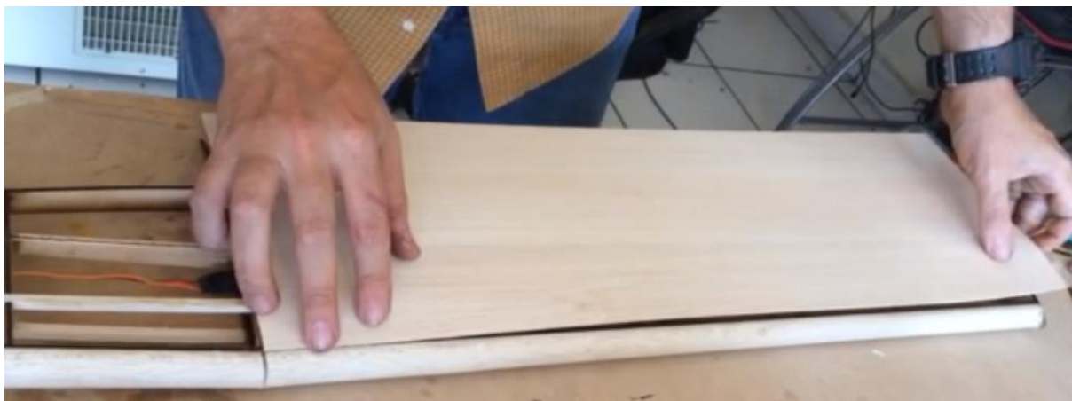
Figura 69 Recubrimiento con balsa
