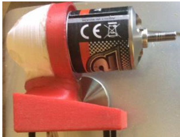
Figura 74 Base del motor impresa en 3D
