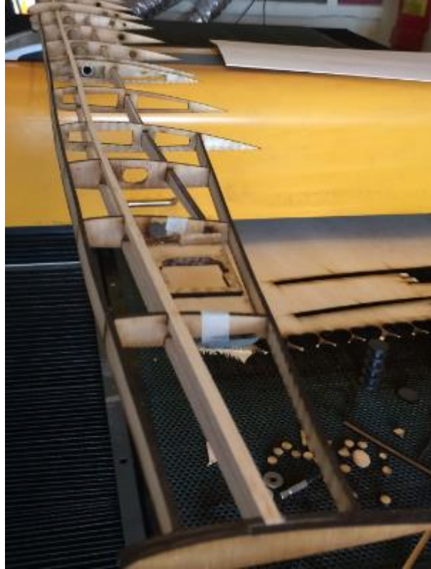
Figura 65 Estructura del conjunto alar
