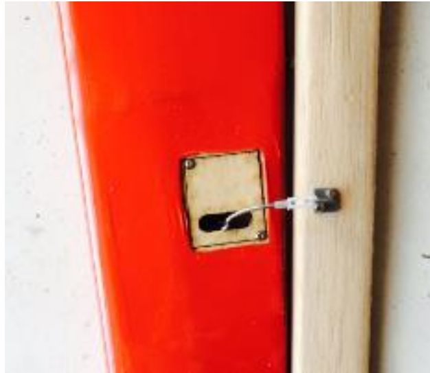
Figura 84 falla del mecanismo para mover el alerón
