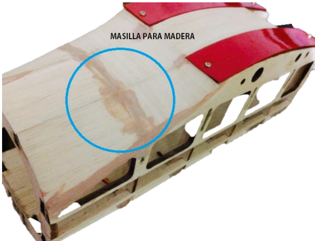
Figura 70 Recubrimiento y corrección de fallas con masilla sobre el fuselaje
