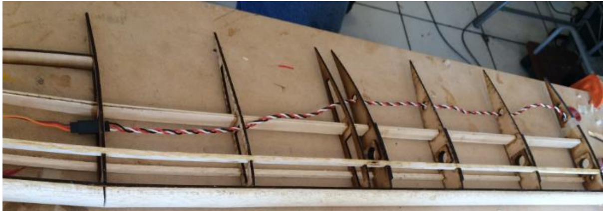
Figura 68 Extensión para servomotor del ala derecha
