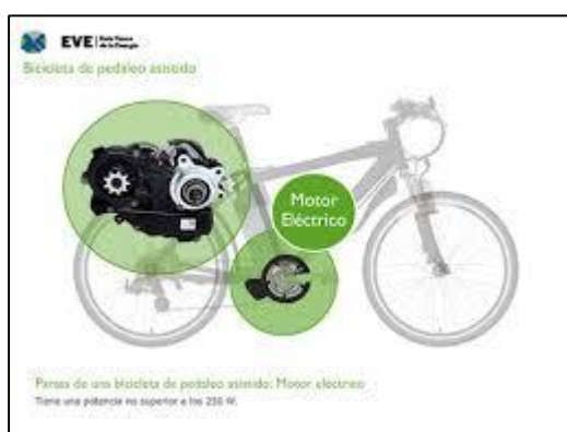
Ilustración 39. Foto motor eléctrico instalado en el pedalear Fuente: (Benavides, 2011)
