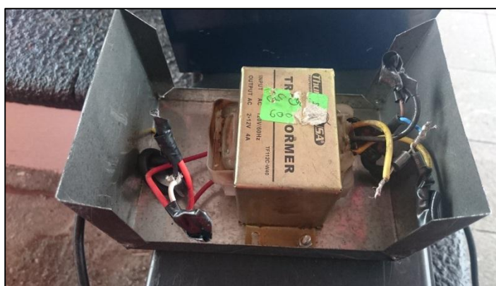
Ilustración 46. Construcción de cargador de las baterías Fuente: Investigación propia
