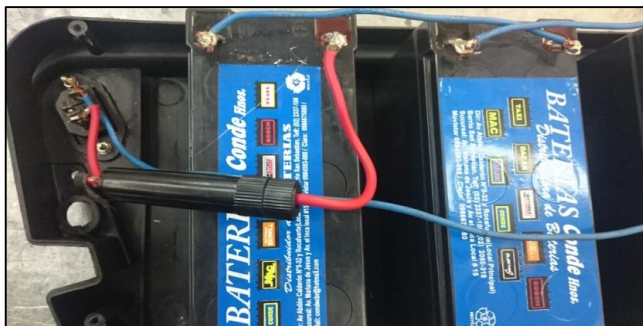
Ilustración 45. Conexión en serie Fuente: Investigación propia
