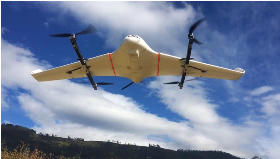
Figura 34: UAV VTOL en vuelo modo copter
