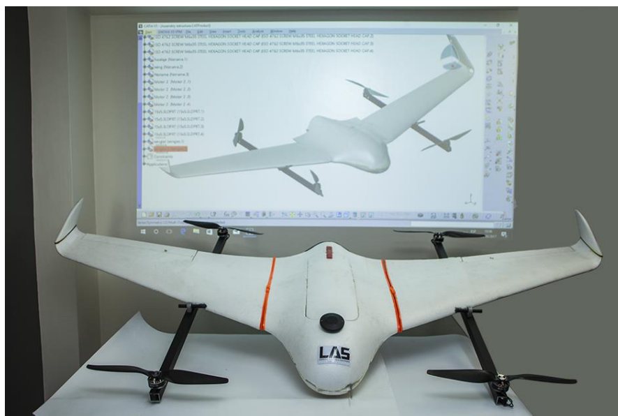
Figura 33: Prototipo UAV VTOL completo junto al diseño CAD
