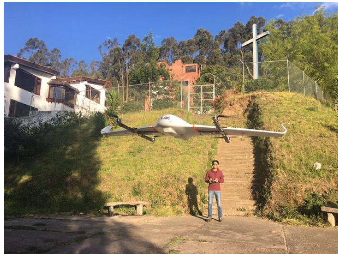
Figura 35:Primer vuelo de prueba del UAV VTOL en modo copter
