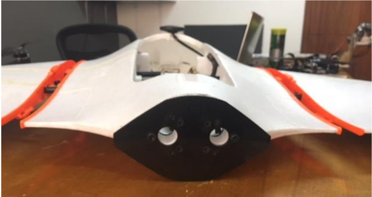
Figura 31: Pared corta fuego para montura de motor
