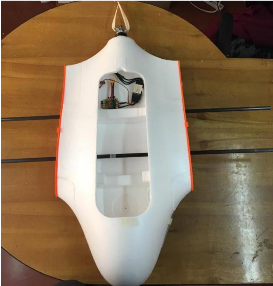
Figura 16: Fuselaje del ala voladora, con tubos de fibra de carbono de 12mm x 8 mm
