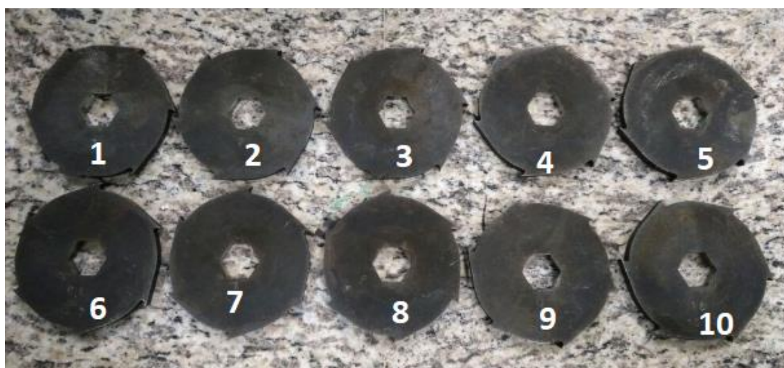
Figura 56. Diez diferentes cuchillas cementadas de la trituradora.
