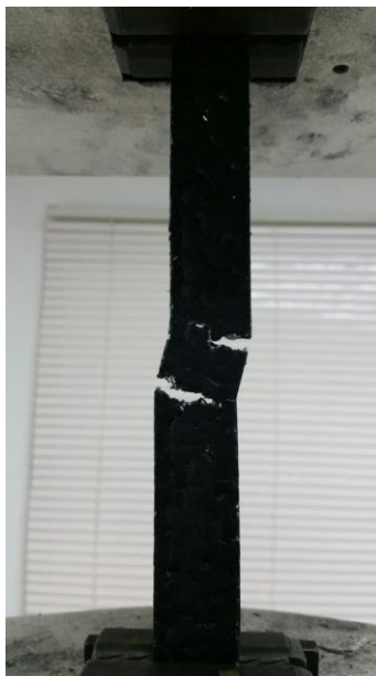
Figura 81. Resultado del ensayo de tensión de la probeta de material compuesto de PP-Al.
