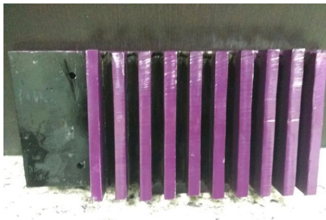
Figura 57. Placa lateral 1 cortada por plasma con las guías incorporadas vista frontal.
