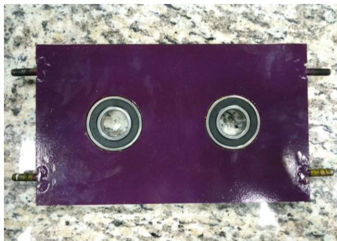
Figura 54. Placa base cortada por chorro de agua con rodamientos colocados.
