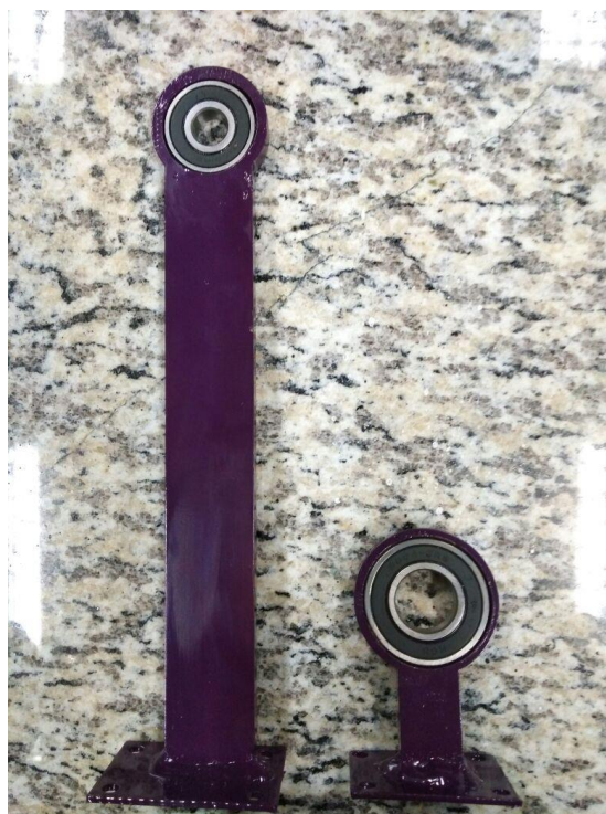
Figura 59. Soporte 1 y 2 con rodamientos colocados.
