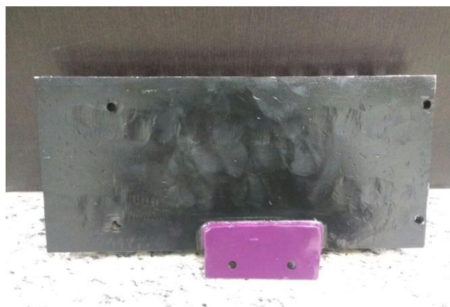
Figura 58. Placa lateral 2 cortada por plasma con las guías incorporadas vista posterior.
