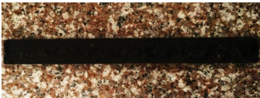
Figura 79. Probeta de material compuesto de PP como matriz y PET como refuerzo basado en la norma ASTM D3039.
