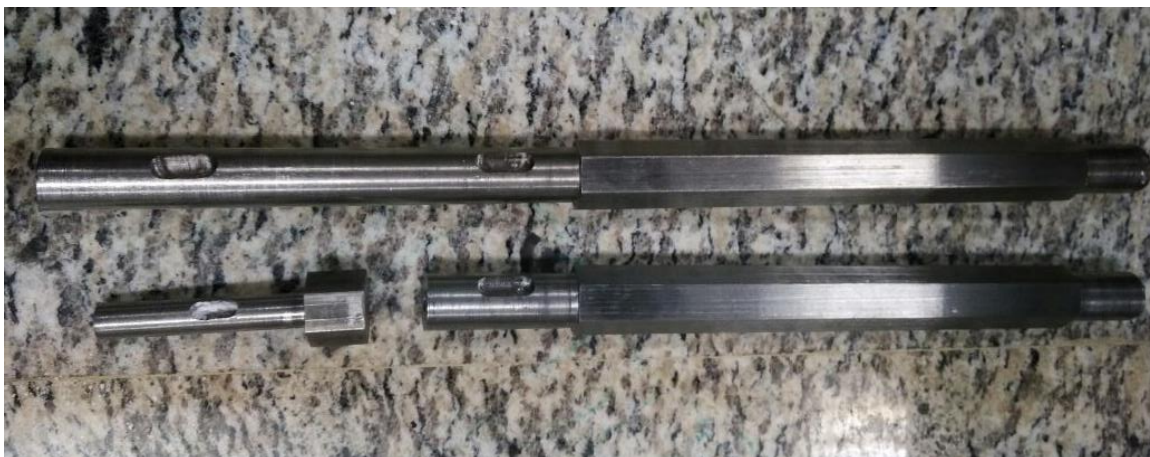
Figura 62. Ejes principales y eje secundario con chaveteros.
