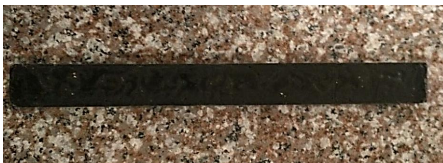
Figura 80. Probeta de material compuesto de PP como matriz y Aluminio como refuerzo basado en la norma ASTM D3039.
