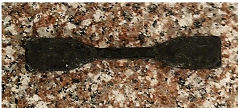
Figura 77. Probeta del PP basado en la norma ASTM D638-14.
