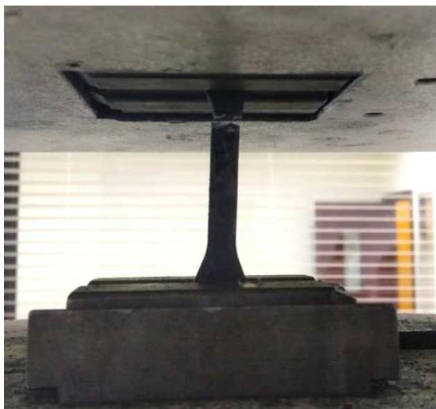
Figura 78. Resultado del ensayo de tensión en la probeta de PP.
