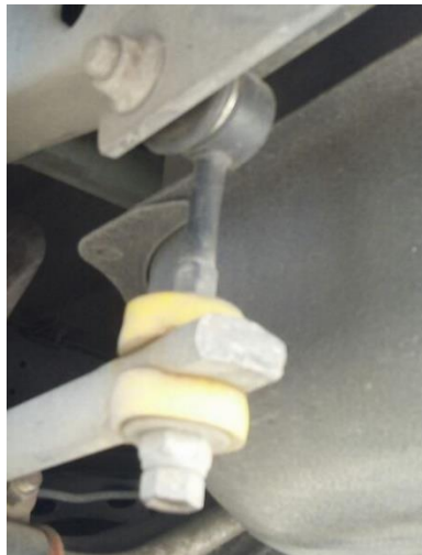
Figura 4. 39. Colocación de perno estabilizador
