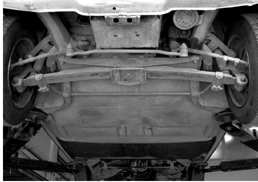
Figura 3. 1. Ballestas dispuestas transversalmente Fuente: Autoescuelas, (2017)
