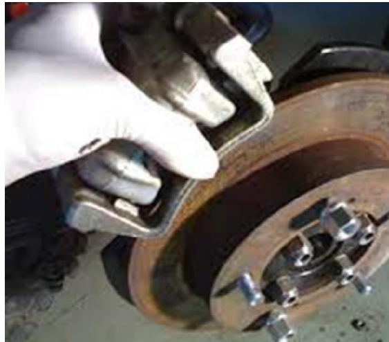
Figura 4. 28. Reemplazando discos de freno de vitara Fuente: El autor
