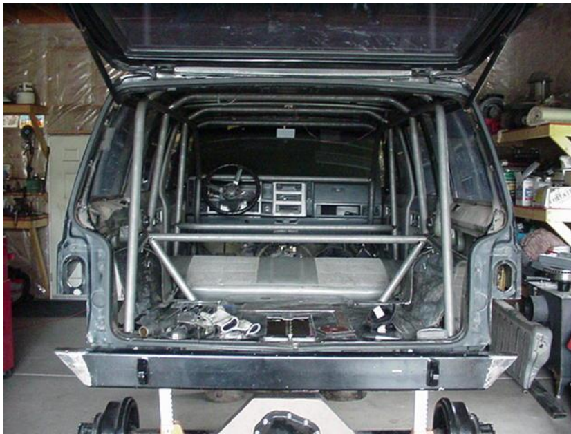
Figura 4. 1. Jaula de seguridad Fuente: Iglesias Castro (2013)
