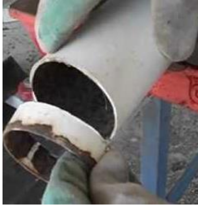
Figura 4. 9. Corte de tubo S355 con amoladora Fuente: El autor
