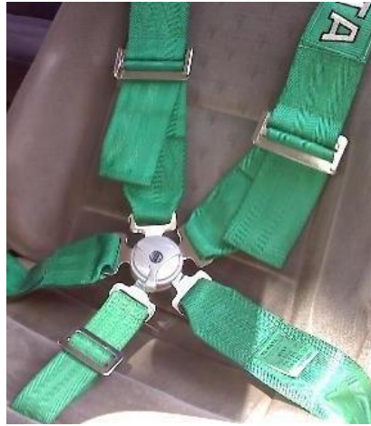
Figura 4. 18. Instalación de cinturón takata asiento conductor Fuente: El autor
