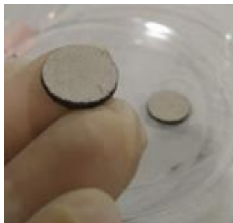
Ilustración 4. Pastilla de cobre pintada con pasta conductora de plata.
