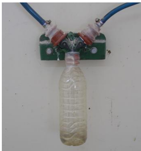
Fig. 3.12. Condensador o trampa de vapor
