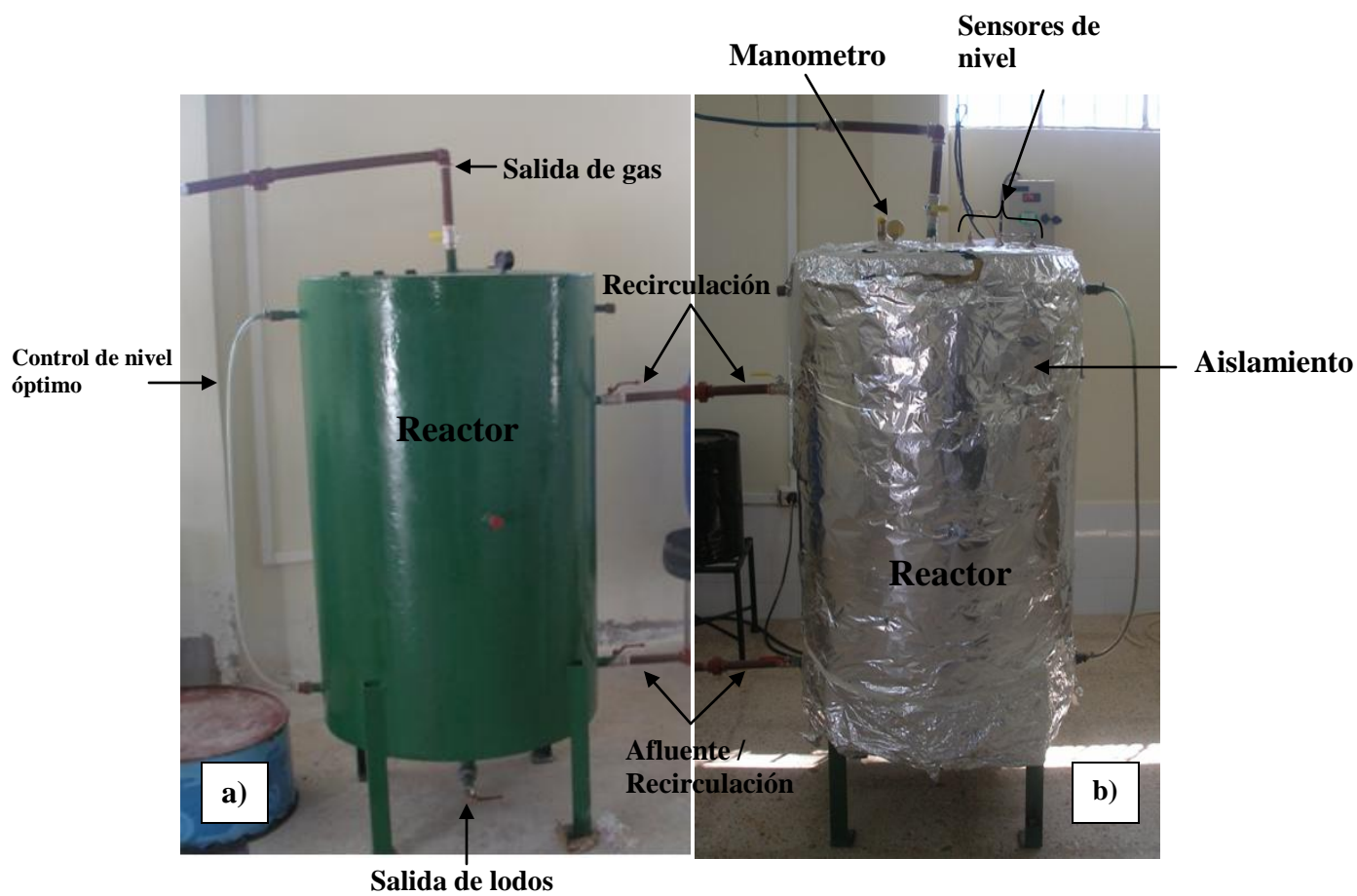
Fig. 3.10. Reactor semi-continuo para la digestión anaerobia. a) sin aislamiento térmico, b) con aislamiento.
