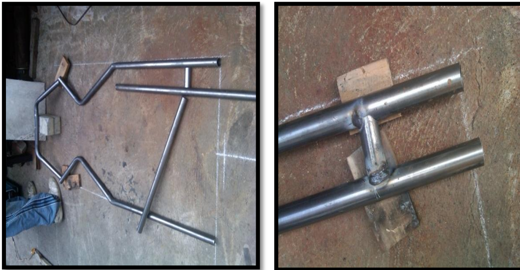
Figura N. 18 Soldadura y Construcción del chasis
