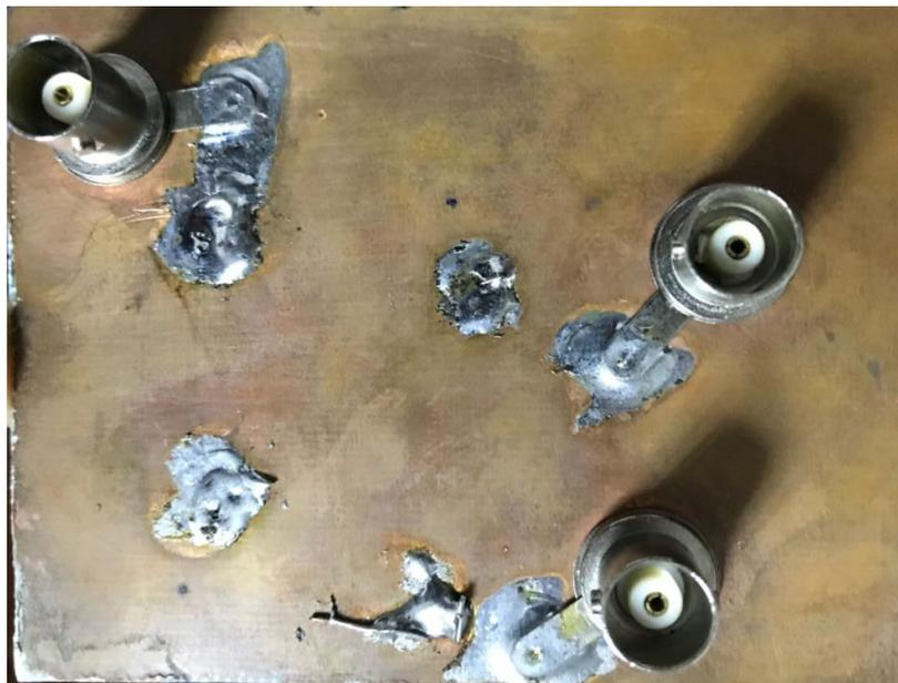
**Figura 37:** Vista inferior de la placa del divisor de potencia Wilkinson
