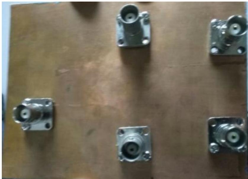
**Figura 66:** Vista inferior de la placa para un Mezclador Balanceado de 90°
