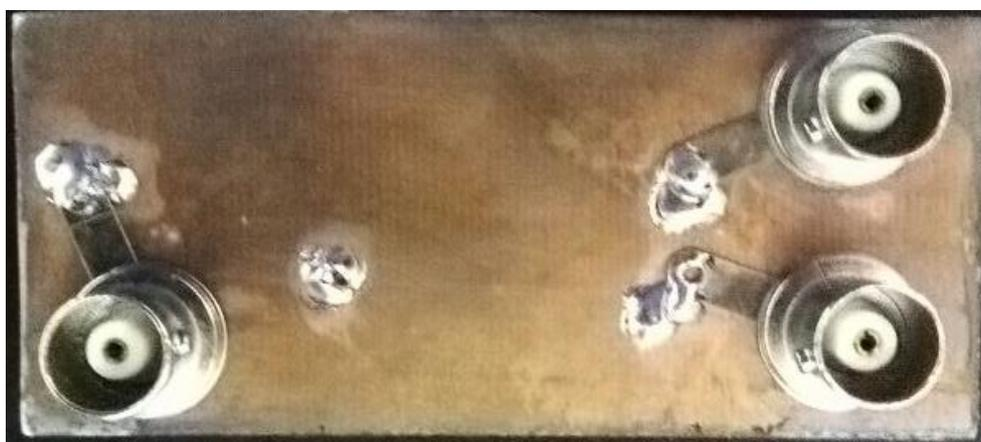
**Figura 18:** Vista inferior de la placa del divisor de potencia Wilkinson
