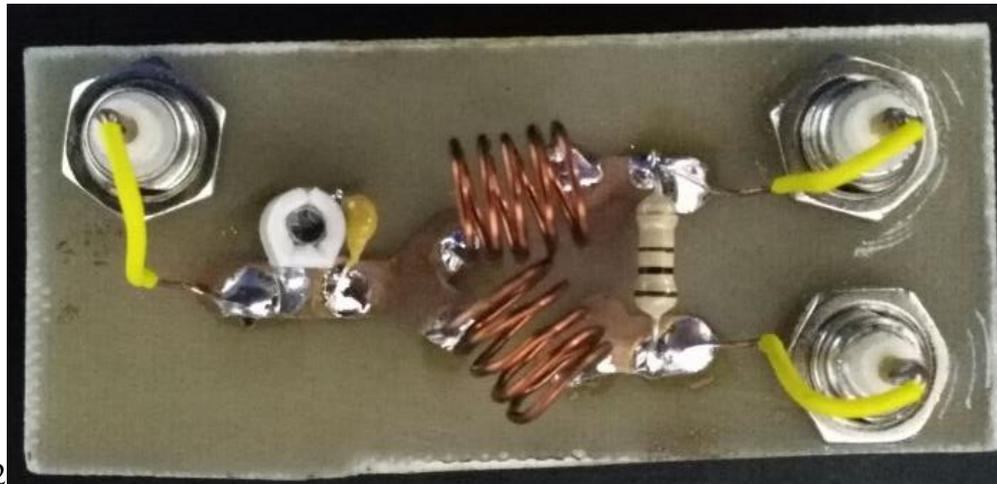
**Figura 17:** Vista superior de la placa del divisor de potencia Wilkinson
