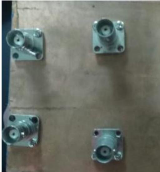
**Figura 54:** Vista inferior de la placa del acoplador de cuadratura.
