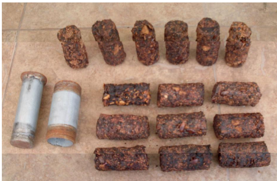
Figura 3.1.- Pistón manual de compresión de bio-briquettes y un arreglo de bio-briquettes de laboratorio
