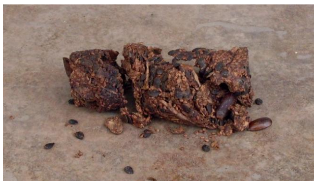
Figura 4.15.- Desmoronamiento de un bio-briquette tras aplicación de presión transversalmente.
