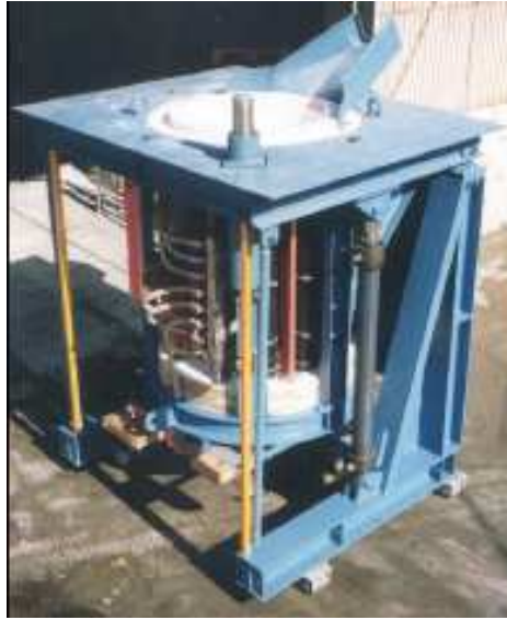
Figura 1.6 Horno de inducción con núcleo magnético Modelo PMF Tomado de: Insertec, 2005b.
