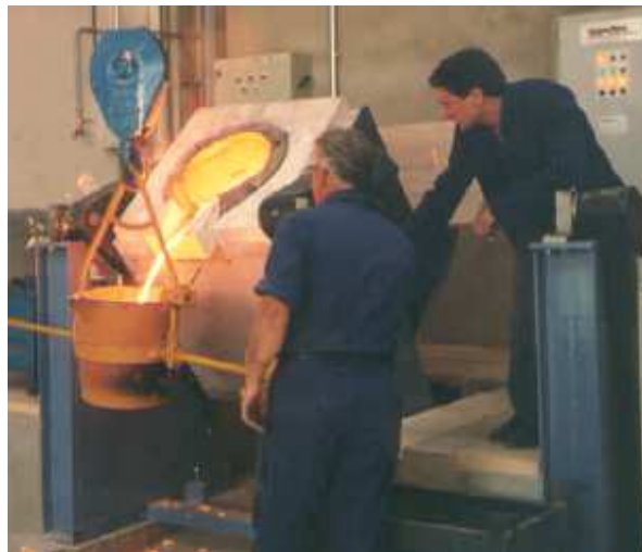
Figura 1.5 Horno de inducción modelo AMFH de Insertec sin núcleo magnético. Tomado de: Insertec, 2005a. Este horno incluye un sistema basculante que permite el colado del metal líquido.
