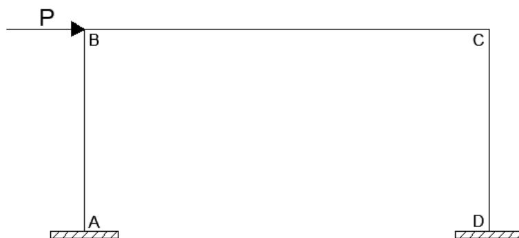
Figura 3 Pórtico simple empotrado con cargas laterales
