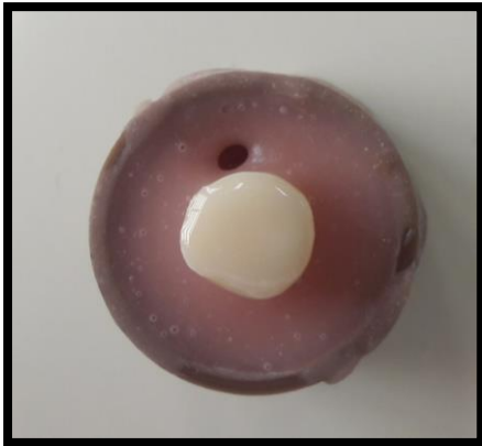
Anexo E: realización de los cortes del conjunto diente-cerámica para obtener cuerpo de 1 mm x 1mm
