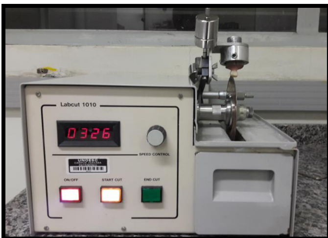
Anexo E: realización de los cortes del conjunto diente-cerámica para obtener cuerpo de 1 mm x 1mm
