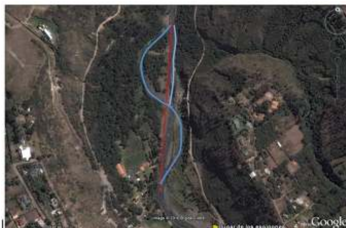
Figura 7-1: Modificaciones del alineamiento del río.
