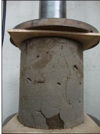
**Figura 31:** Rotura de cilindros
