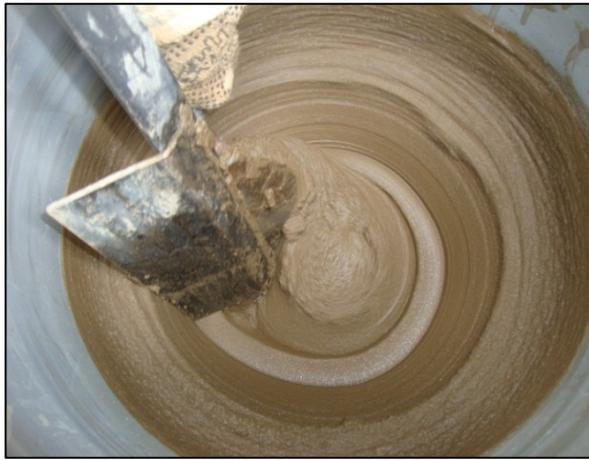
**Figura 10:** Mezcla con aditivo Espumer
