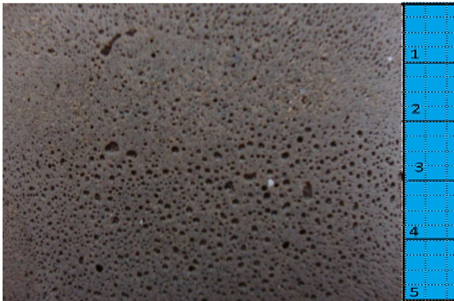
**Figura 26:** Estructura interna “Fill Flow”
