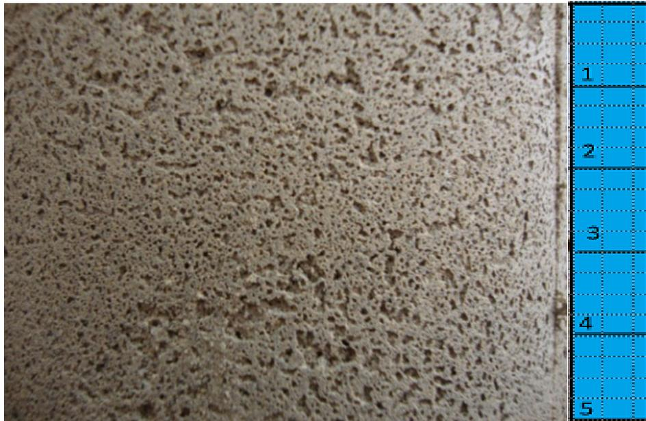
**Figura 25:** Estructura interna “Barracell”
