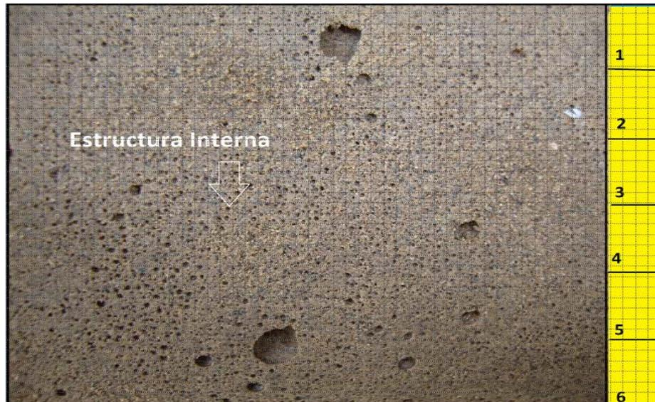
**Figura 23:** Estructura interna con “Espumer” (cm)
