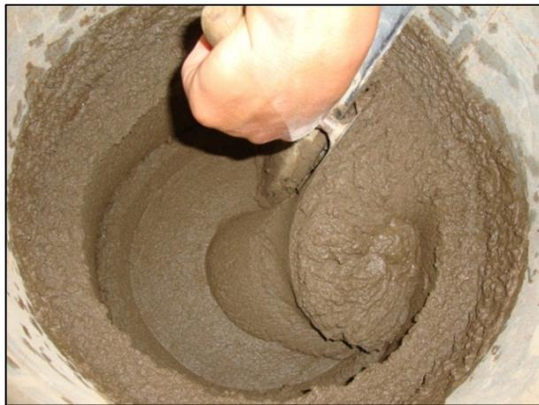
**Figura 11:** Mezcla con aditivo Megamix
