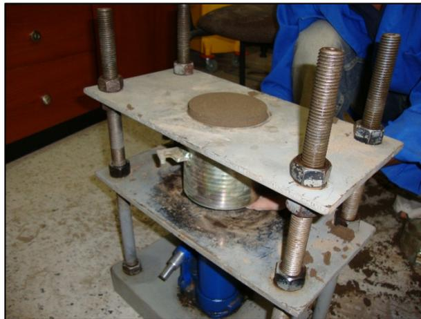
**Figura 18:** Extracción de la muestra
