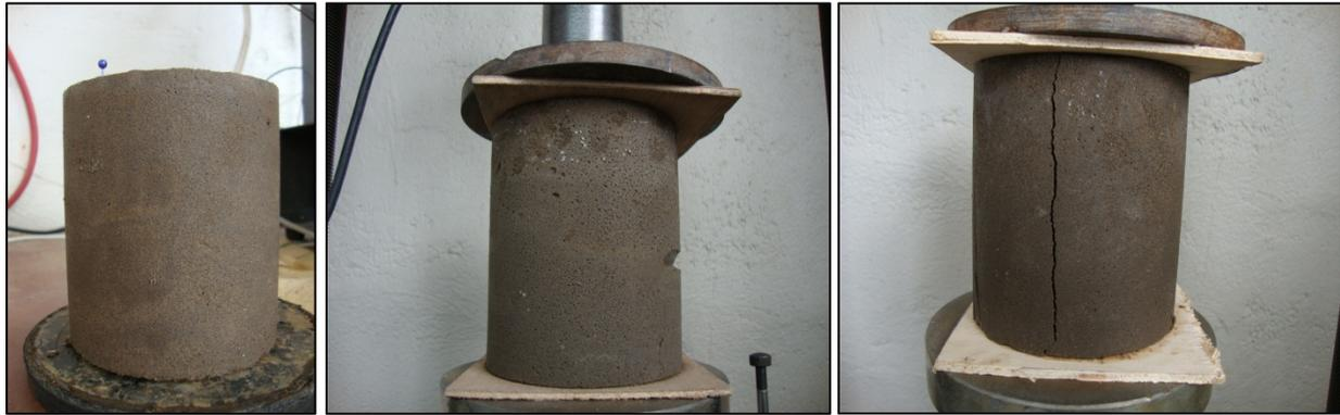
**Figura 21:** Rotura de Cilindros
