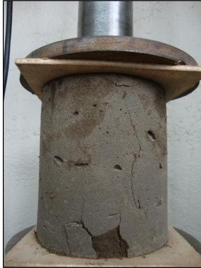
**Figura 31:** Rotura de cilindros
