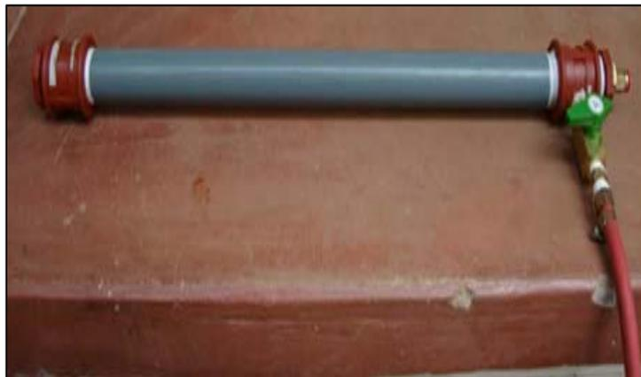
**Figura 12:** Generador de espuma.
