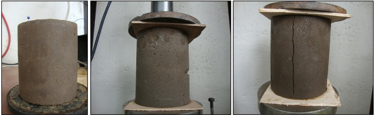
**Figura 21:** Rotura de Cilindros
