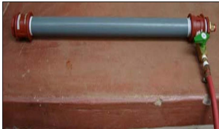
**Figura 12:** Generador de espuma.
