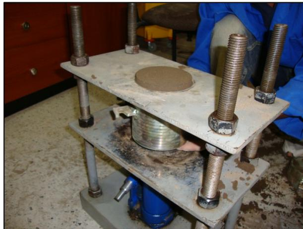
**Figura 18:** Extracción de la muestra
