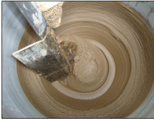
**Figura 10:** Mezcla con aditivo Espumer
