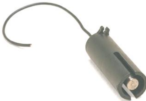
Figura 3.22: Sensor de nivel del agua del gasómetro [39]
