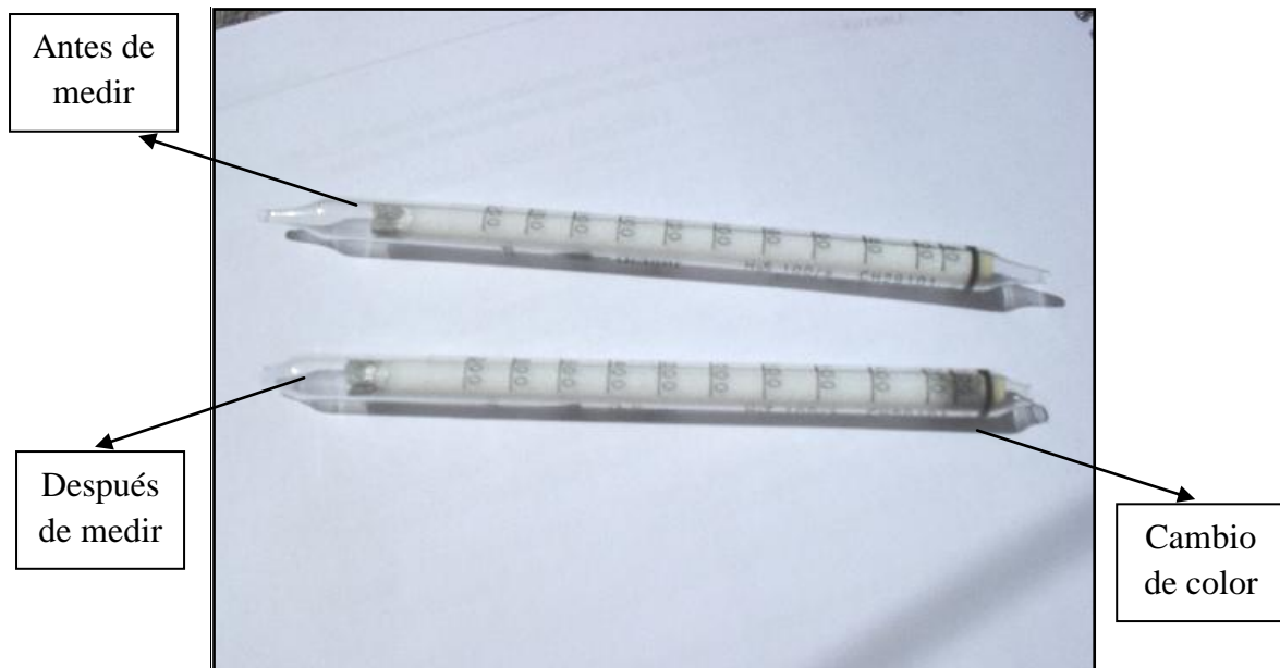
Figura 3.7: Medición del contenido de H_2S del biogás producido en la planta piloto de digestión anaerobia del LaDEA
