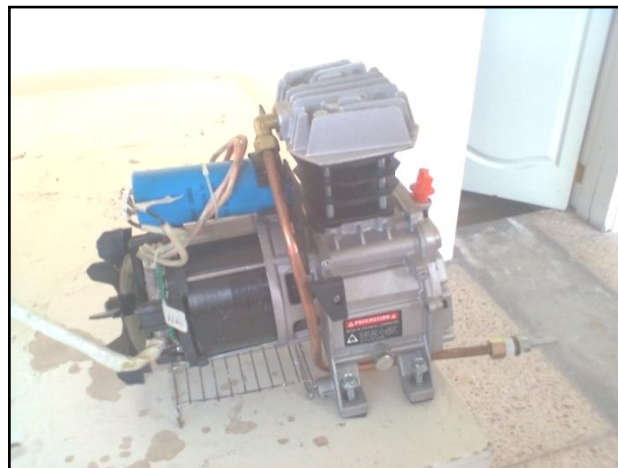
Figura 3.24: Motor del compresor
