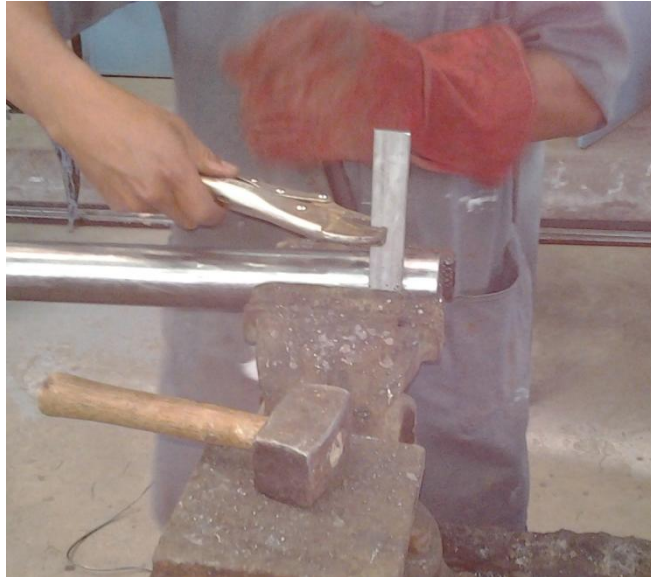
Ilustración 54.- Formado del anillo con combo.
