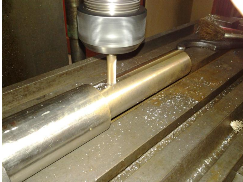
Ilustración 49.- Fresado de chavetero
