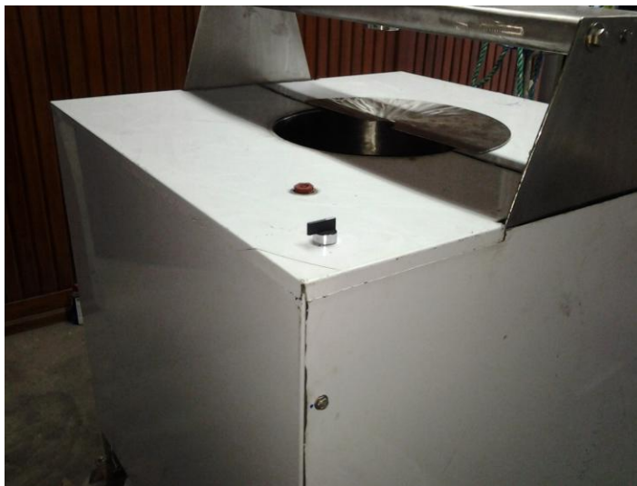
Ilustración 67.- Tapa superior huecos botón de encendido y tapa sistema de calentamiento
