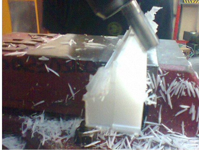
Ilustración 59.- fresado para dar forma de cuña al Segundo raspador
