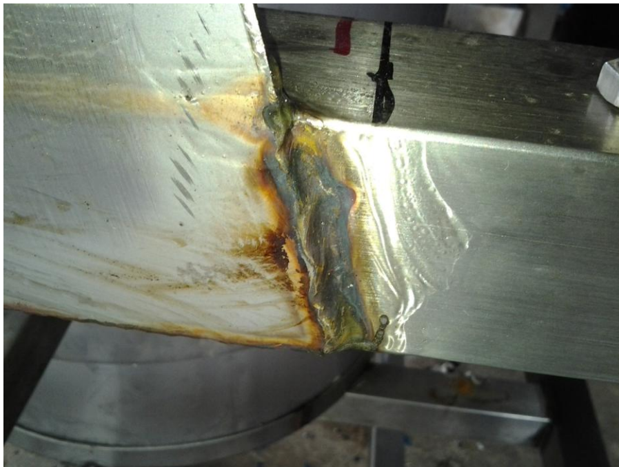
Ilustración 37.-Decapado de soldaduras
