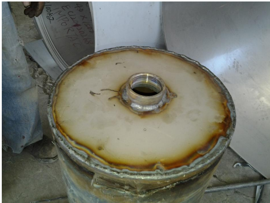
Ilustración 41.- suelda acople para resistencia
