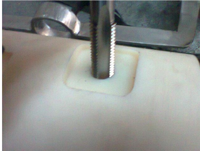
Ilustración 65.- Apertura de rosca con machuelo de \frac{3}{4} "
