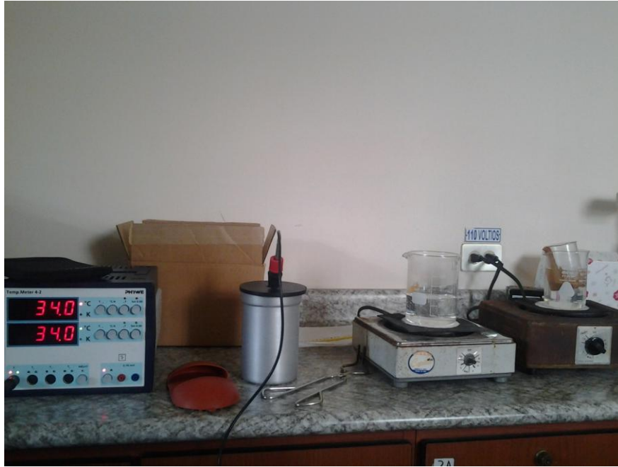
Ilustración 9.- Conexión del Medidor digital con el calorímetro
