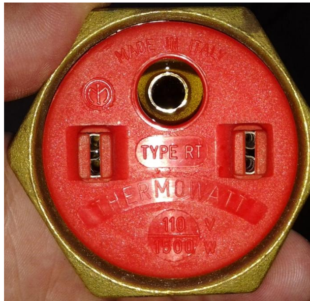
Ilustración 17.- Resistencia eléctrica seleccionada
