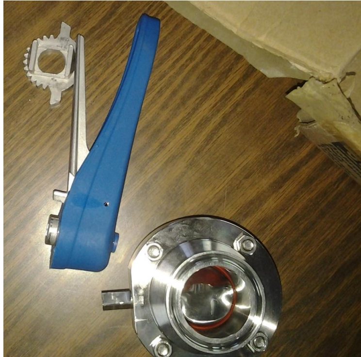
Ilustración 77.- Válvula de mariposa tipo clamp
