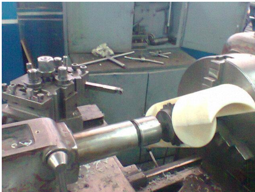
Ilustración 66.- Cilindrado del Raspador del fondo
