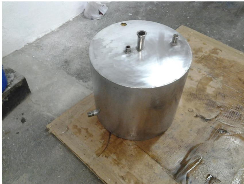
Ilustración 29.- Cilindro completamente lijado y acabado
