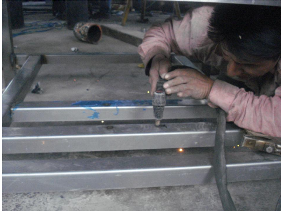
Ilustración 36.- Corte de Orificios para sujeción de bomba
