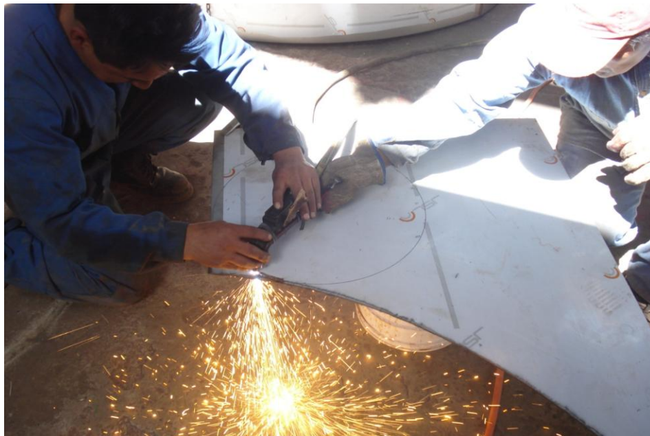
Ilustración 23.-Corte con plasma tapa del cilindro
