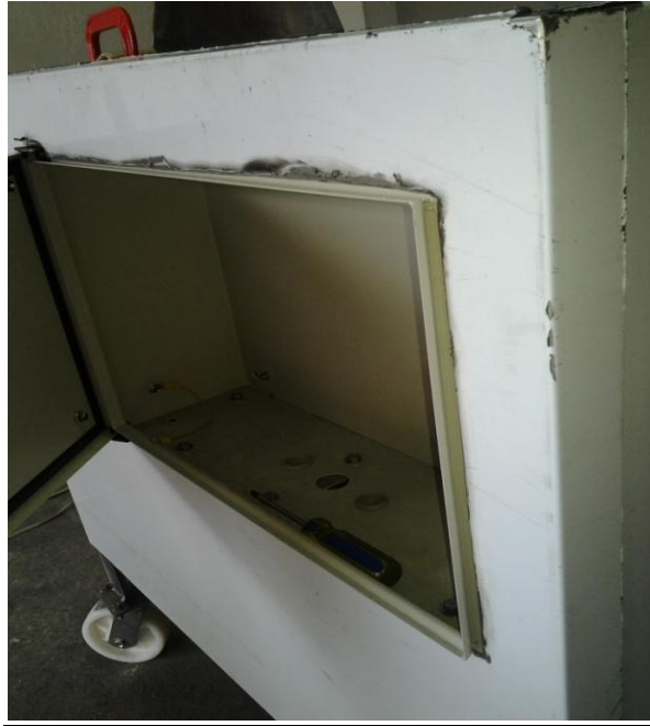
Ilustración 69.- Ensamble tapa frontal y caja de control
