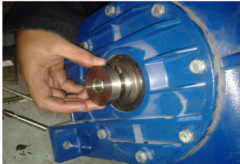
Ilustración 52.-Arandela fabricada para ayudar al tornillo a sujetar el eje
