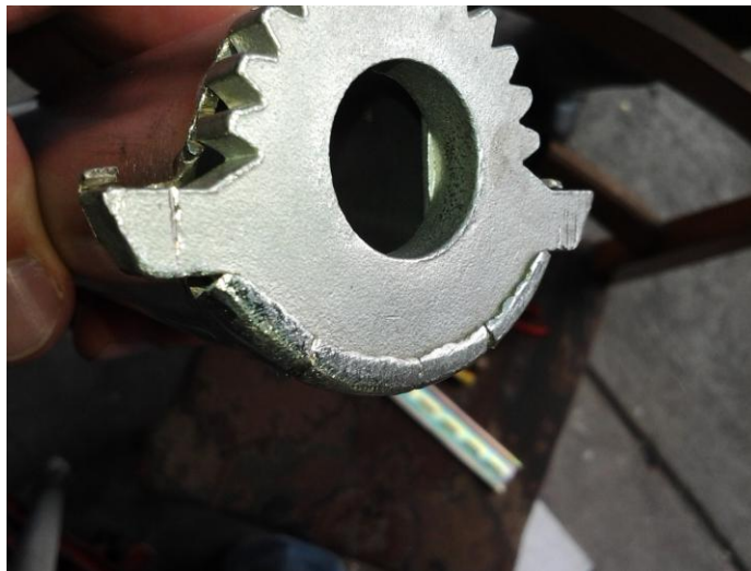
Ilustración 78.- Acople para soporte de la manija de la válvula de mariposa
