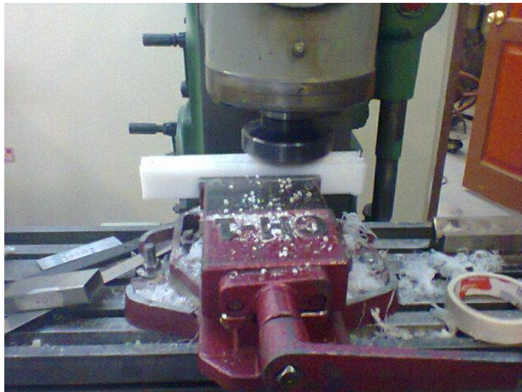
Ilustración 58. -fresado para igualar caras en placas de teflón de raspadores
