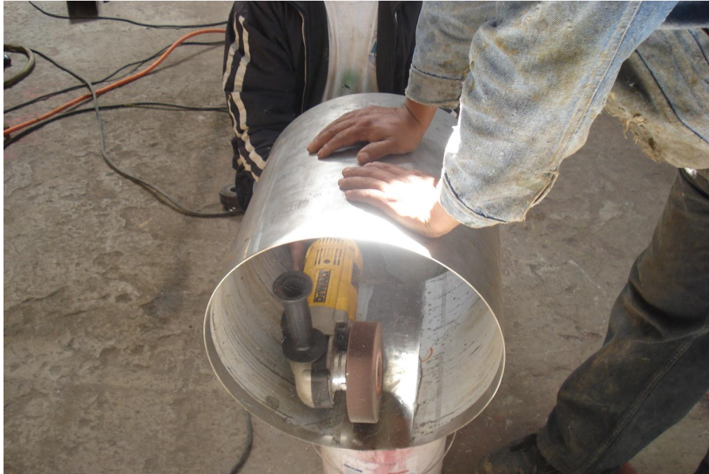
Ilustración 22.-Pulido de suelda
