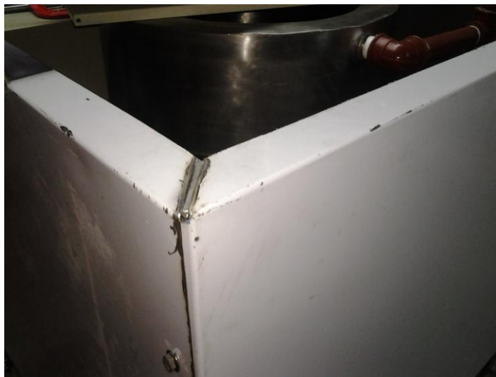
Ilustración 68.- Ensamble tapa posterior y tapa lateral
