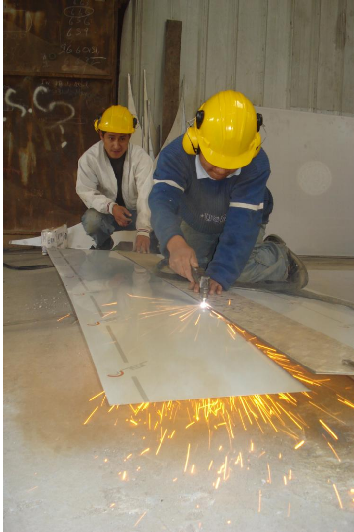
Ilustración 21.-Corte plancha de acero con regla
