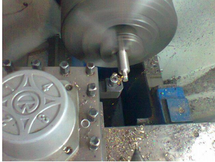
Ilustración 60. -Refrendado perno de acero inoxidable de 3/4"
