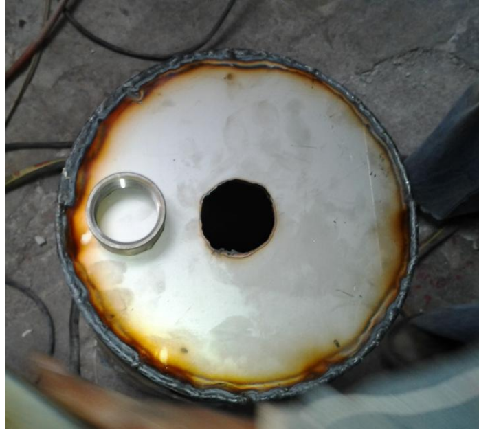
Ilustración 40.- Apertura agujero para resistencia en reservorio
