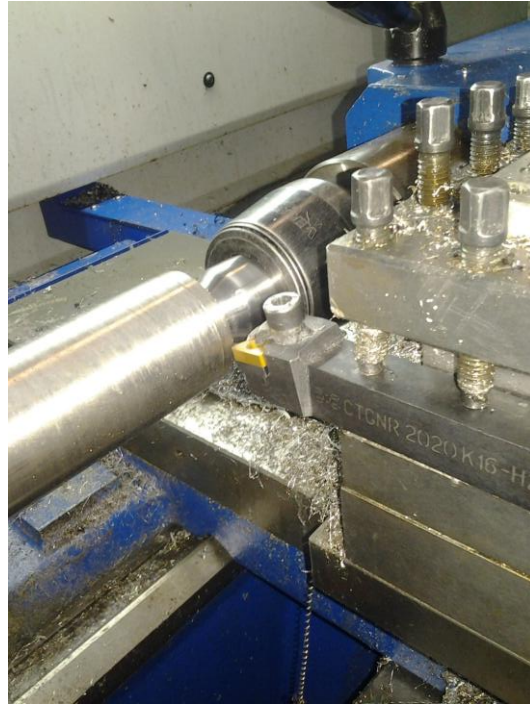
Ilustración 48.-Cilindrado con widia
