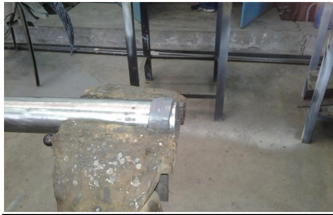
Ilustración 53.- Sujeción en entenalla eje y placa
