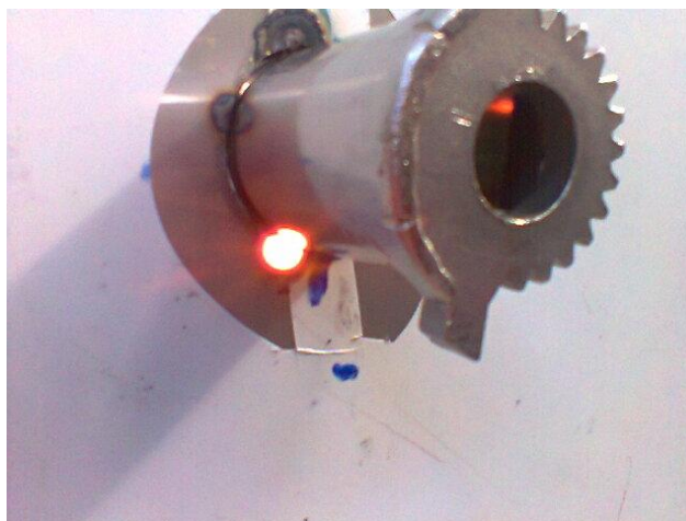
Ilustración 79.- Suelda del acople a la tapa frontal de la estructura
