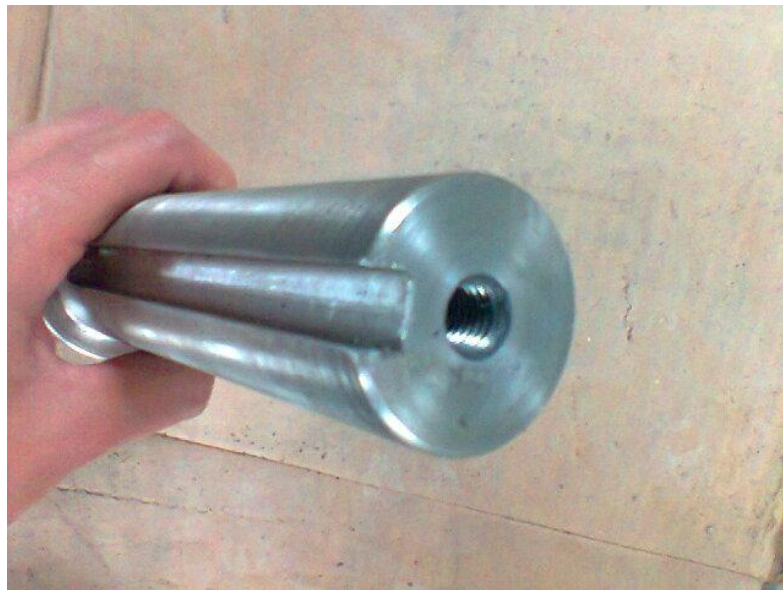
Ilustración 50.- Terminado final maquinado parte superior de eje
