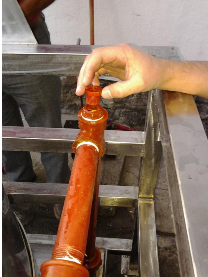
Ilustración 46.- Tapa y orificio por donde se llena el agua del sistema
