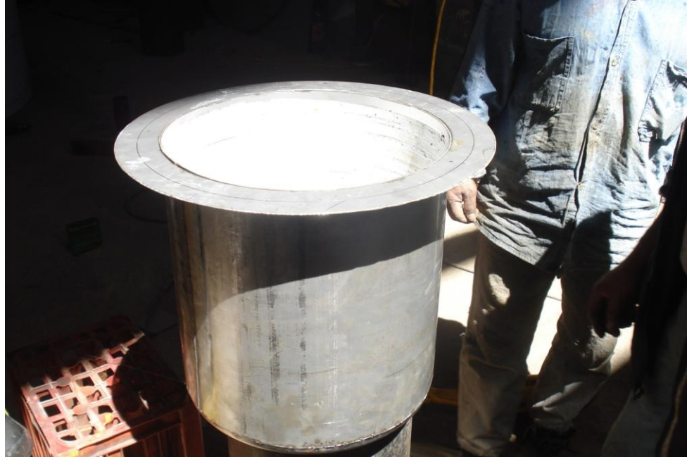
Ilustración 26.- Corte y ensamblaje tapa superior
