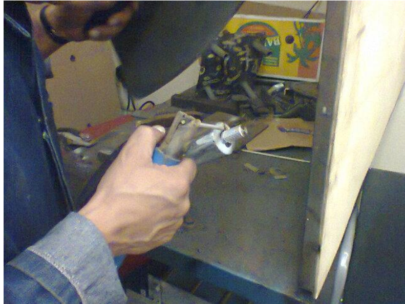
Ilustración 62.- Suelda del perno de \frac{3}{4} " al eje
