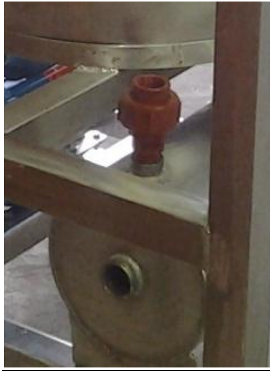
Ilustración 42.- Ensamble Universal entrada de agua al reservorio
