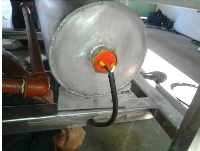
Ilustración 73.- Conexión de la resistencia
