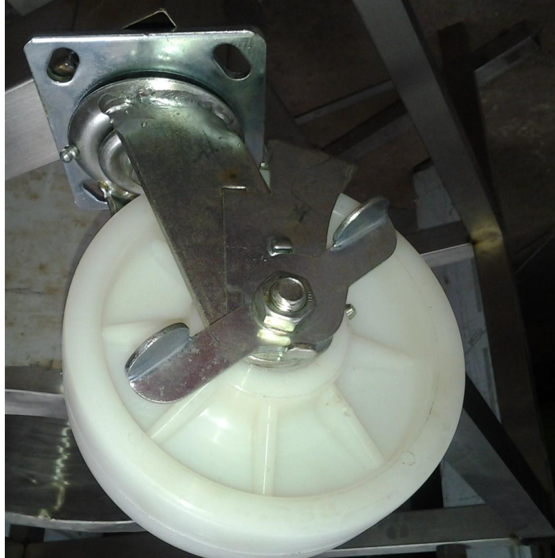
Ilustración 38.- Ruedas giratorias de Nylon
