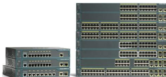
Figura 3.77: Conmutadores Cisco Catalyst 2960
