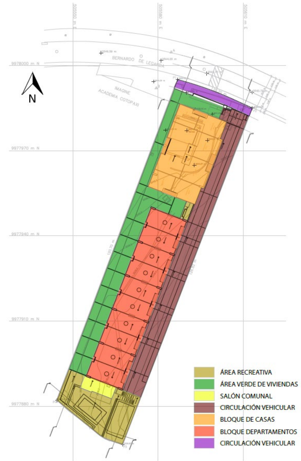
Ilustración 5-13 - Distribución general del Conjunto Figalia Fuente: Arcontec Cía. Ltda. Elaborado por Francisco Guerra
