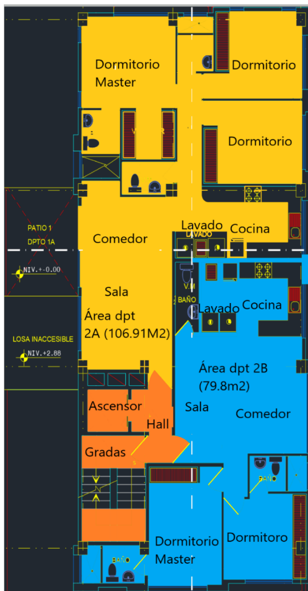
Imagen 43: Distribución Primer y Segundo Piso
