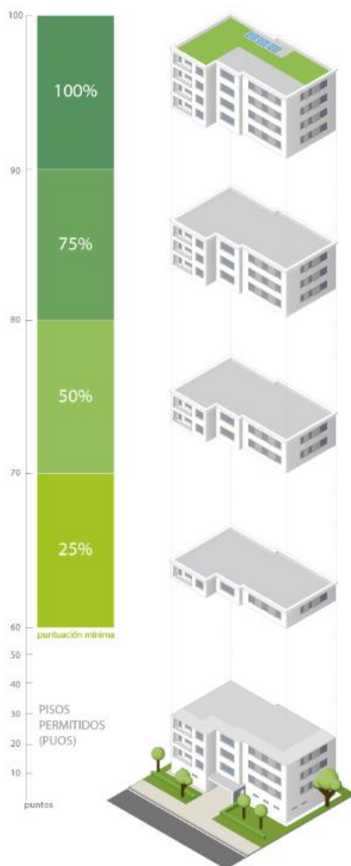
Ilustración 73. Comparación entre calificación de matriz de eco eficiencia y porcentaje en aumento de edificabilidad
