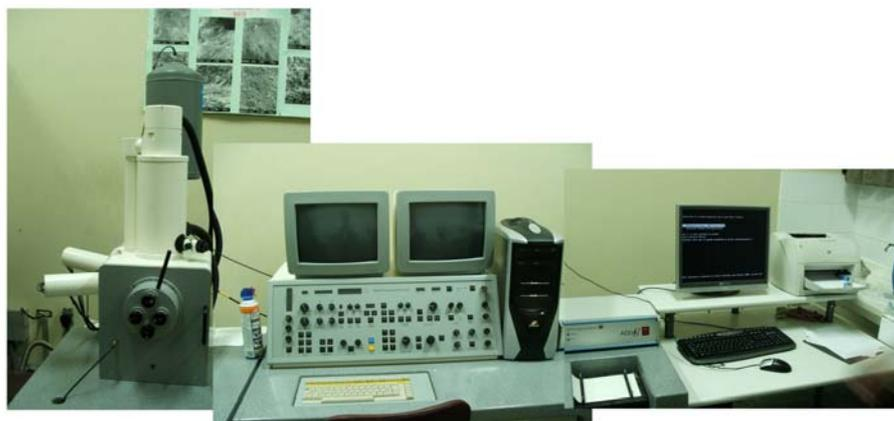
Fig. 3.18: SEM (Microscopio Electrónico de Barrido) de la ESPE
