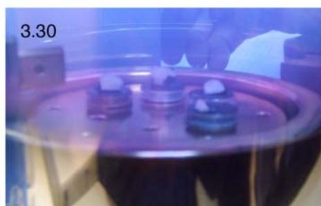
Fig. 3.25 (arriba izquierda): Incrustación de fragmentos; Fig. 3.26 (arriba derecha): colocación de Argón; Fig. 3.27 (centro izquierda): Sputtering System; Fig. 3.28 (centro derecha): cubierta de Oro; Fig. 3.29 (abajo izquierda): fragmento de diente colocado en vacum para recibir baño de oro; Fig. 3.30 (abajo derecha): bañado de Oro de fragmento de diente en proceso.
