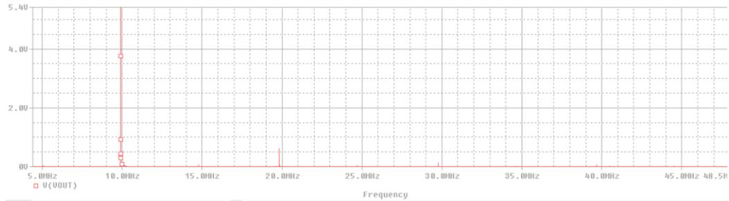
Figura 4: FFT de Simulación Oscilador Colpitts a 10MHz.
