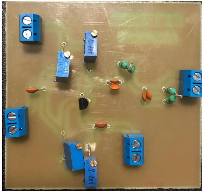
Figura 25: Parte Delantera de la Placa de Mezclador con Oscilador local por el emisor y radio frecuencia en la base.
