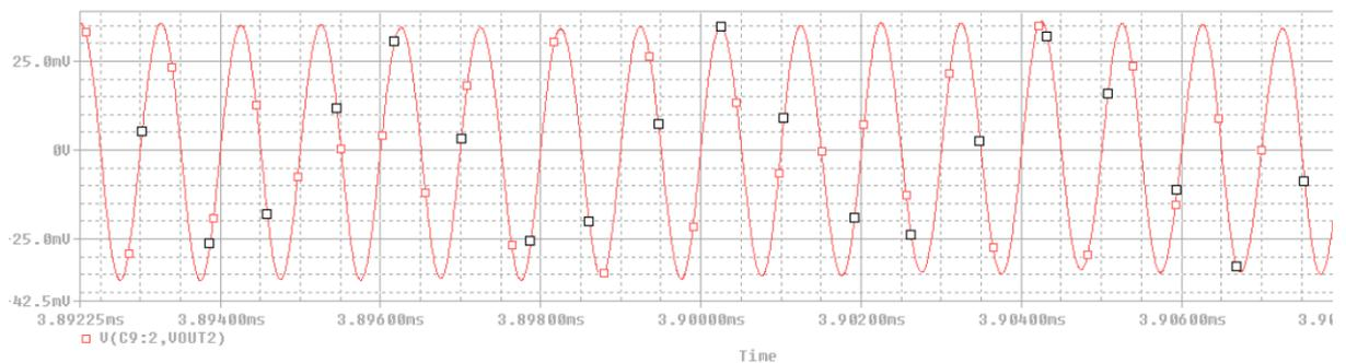
Figura 48: Simulación en Dominio del tiempo de mezclador Gilbert con divisor de voltaje
