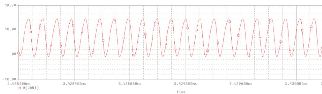
Figura 7: Simulación oscilador Colpitts con buffer de alta impedancia.
