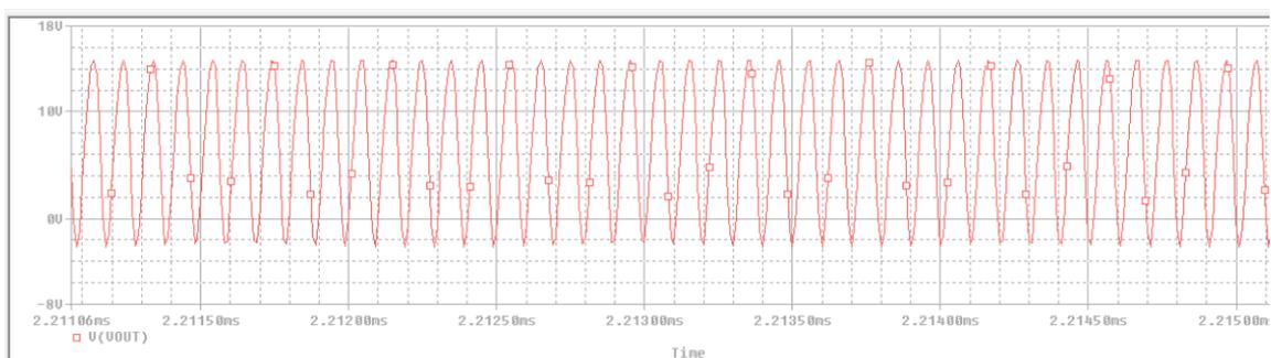
Figura 3: Simulación oscilador Colpitts
