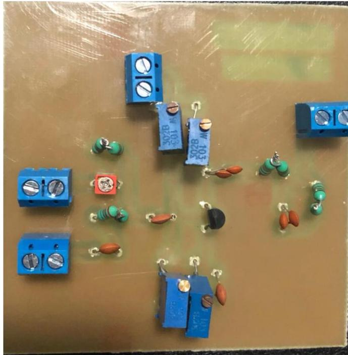
Figura 35: Parte delantera de la placa de Mezclador con Oscilador local y radio frecuencia en la base
