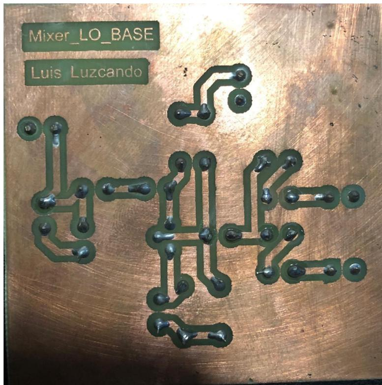
Figura 36: Parte trasera de la placa de Mezclador con Oscilador local y radio frecuencia en la base
