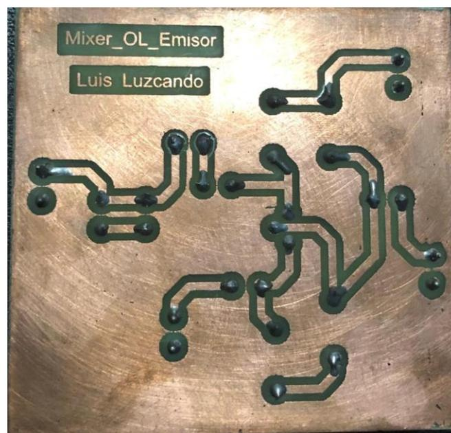
Figura 26: Parte Trasera de la Placa de Mezclador con Oscilador local por el emisor y radio frecuencia en la base.
