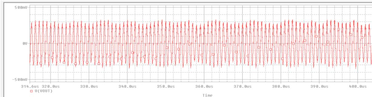
Figura 34: Simulación en función del tiempo de mezclador BJT con Oscilador Local y Radio Frecuencia la base del transistor ante una variación de amplitud de 10 Voltios en OL.
