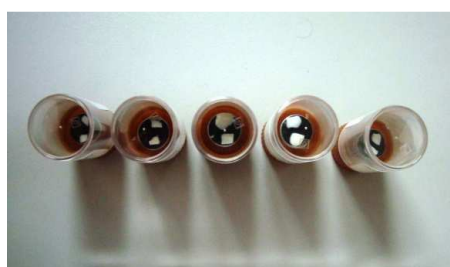
Figura 5. Diez muestras del Grupo 1 ubicadas en portamuestras de aluminio con un pegamento de carbón
