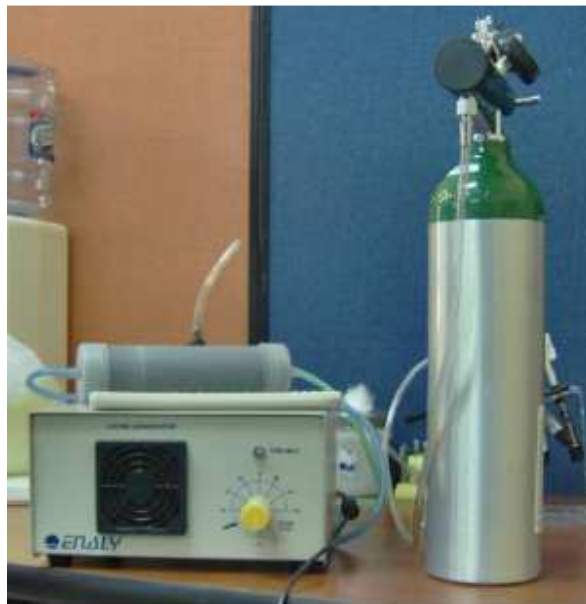
Figura 12 Aparato generador de ozono para uso odontológico.
