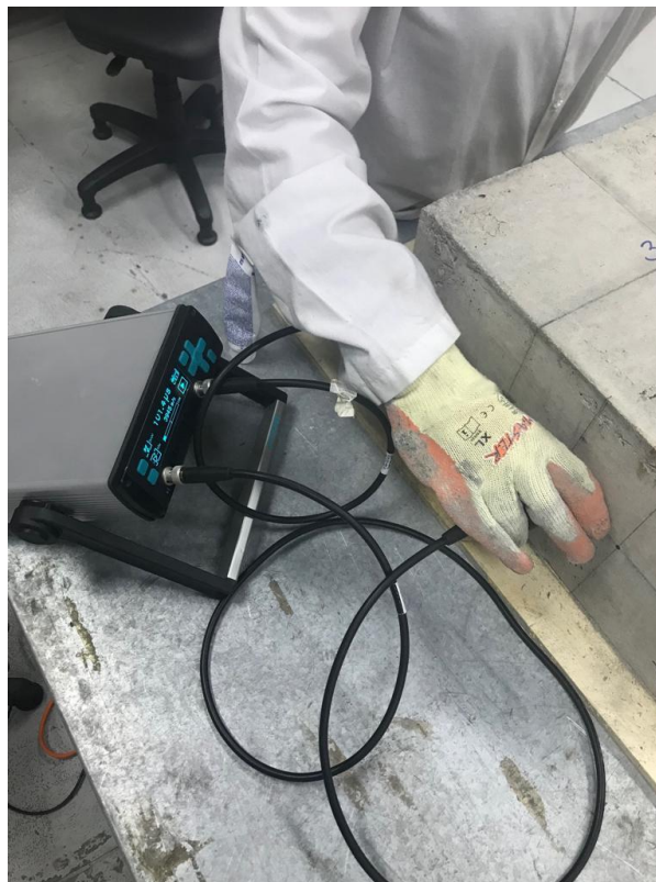
Figura 9: Configuración de velocidad de pulso en laboratorio
