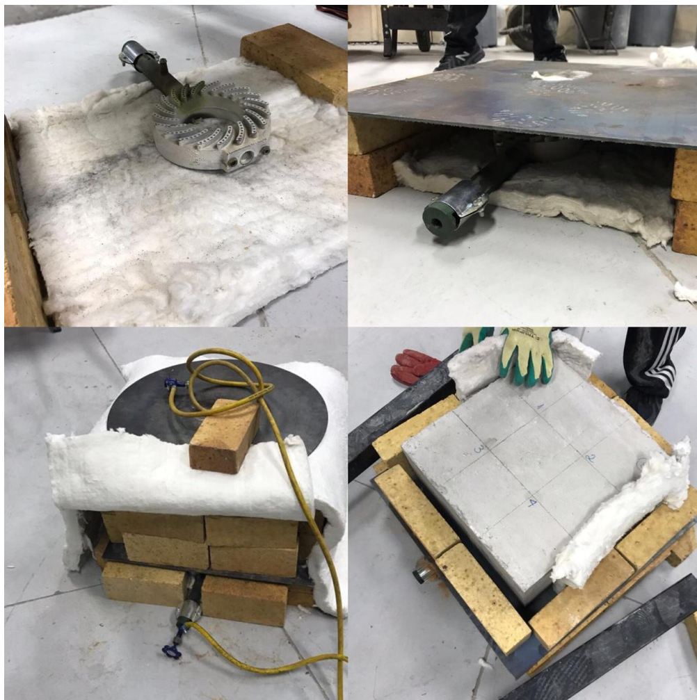
Figura 15: Armado de horno no industrial para exposición a altas temperaturas
