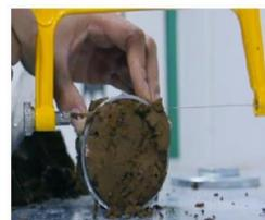
Figura K: *Muestra para el ensayo de Consolidación.*
