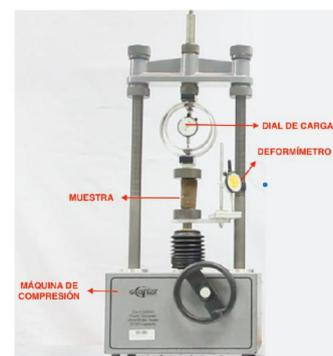
Figura B.7: Configuración del ensayo de compresión simple sin confinamiento.
