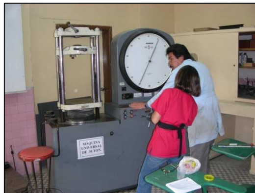
Figura 22. Observación y registro de las cargas que soportaron cada tubo.
