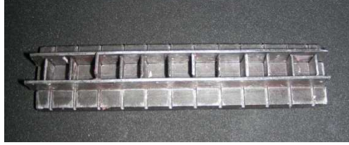
Figura 2. Molde de latón para la confección de los troqueles.
