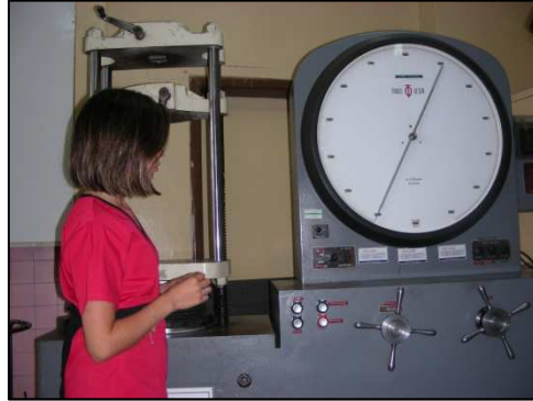
Figura 19. Máquina Universal 30 toneladas
