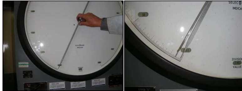
Figura 21. Indicador que mide la carga que soportan los cuerpos.
