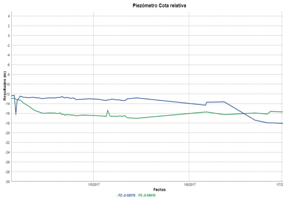
Figura 30. Resultados de la medición de piezómetros en sección de estación (WebGeom, 2018)
