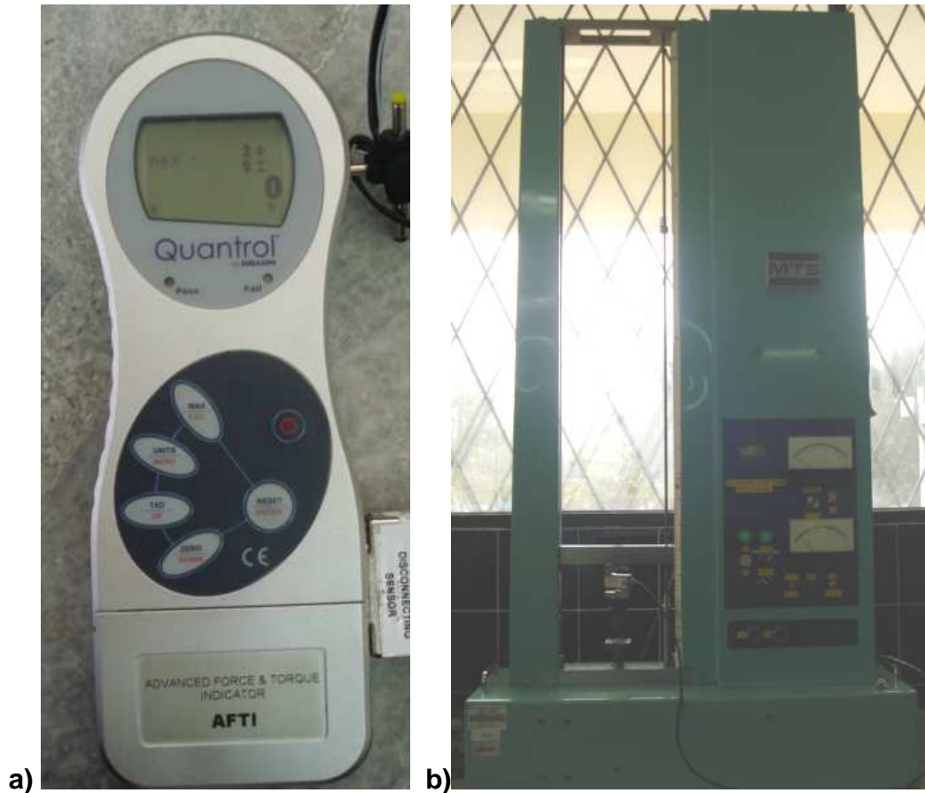
Figura 16. a) Medidor de la fuerza máxima de fractura, b) Máquina de ensayos universal MTS modelo 5000
