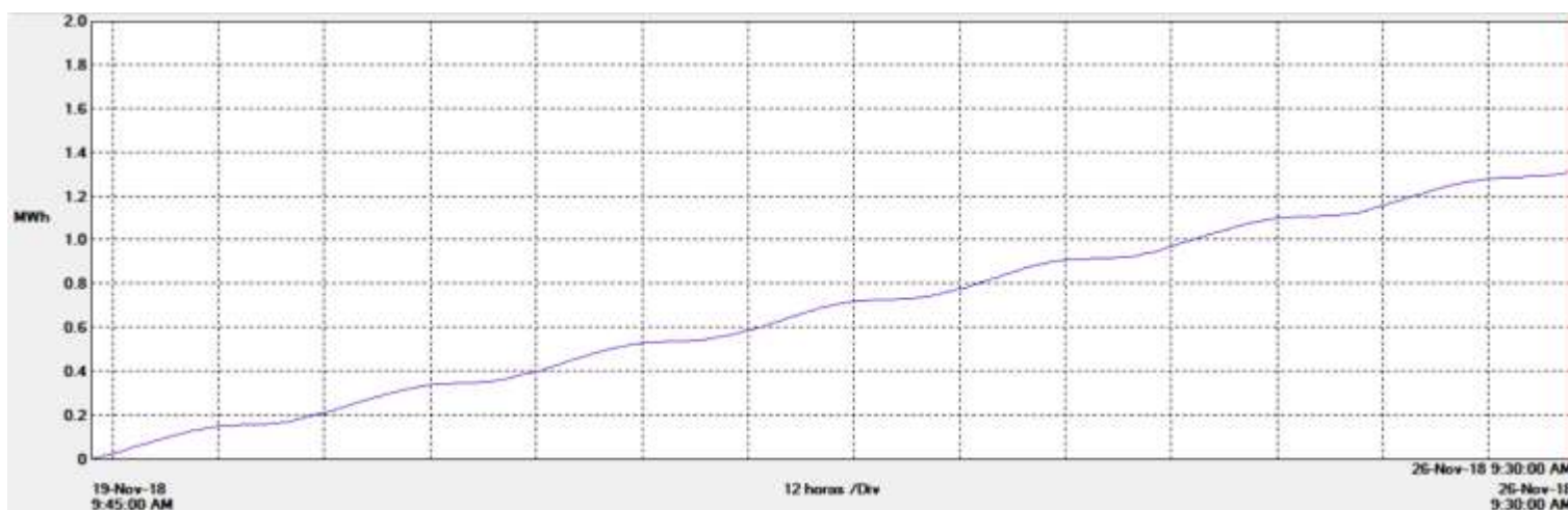
Figura 12. Consumo Eléctrico (kWh) total Acumulado obtenido del tablero de ascensores y escaleras eléctricas
