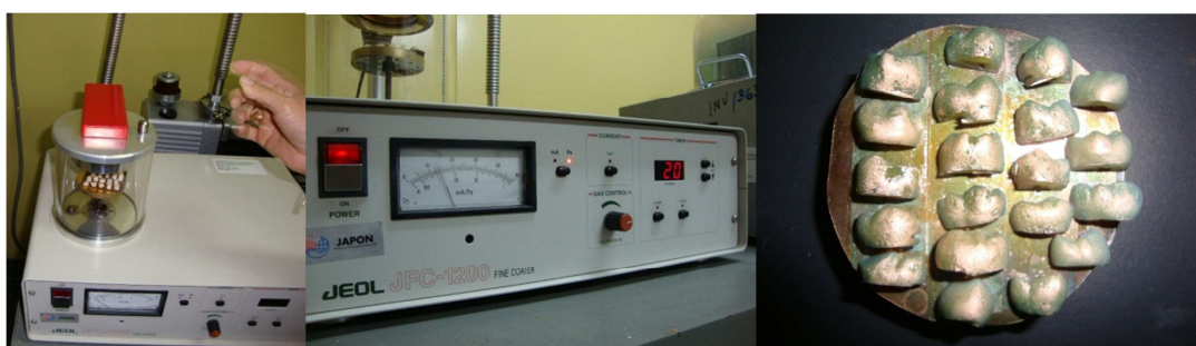
Figura 12. a. Equipo recubridor marca Jeol modelo JFC-1200. b. Las muestras fueron trabajadas a 10KV, durante 20 segundos. c. Muestras recubiertas.
