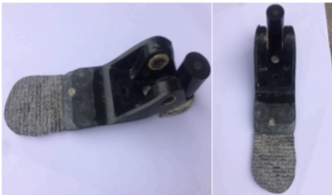
Figura 89: Pie articulado de fibra de carbono.
