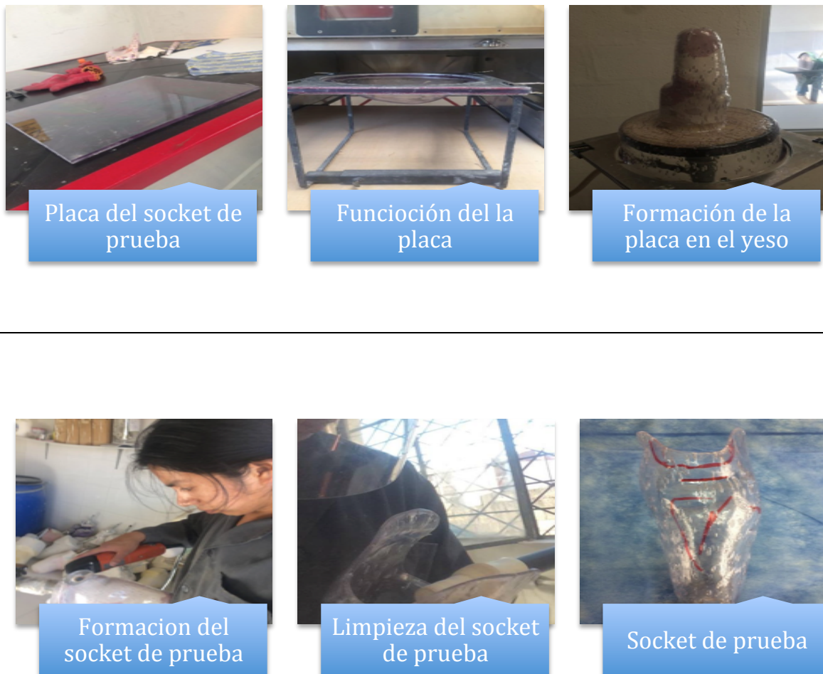
Figura 105: Proceso de fabricación del socket de prueba
