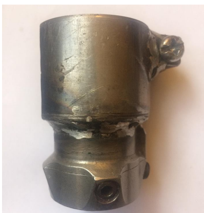
Figura 94: Adaptador tubular de acero.
