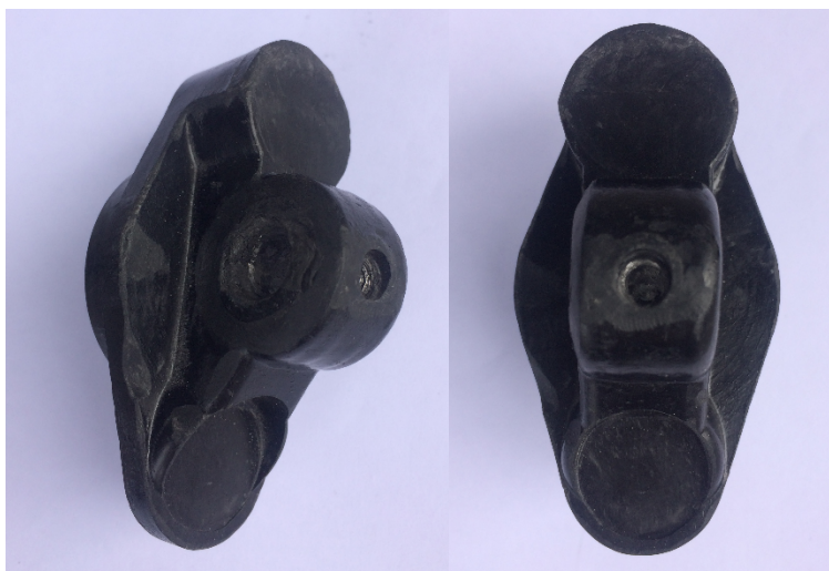
Figura 90: Tobillo articulado de fibra de carbono.
