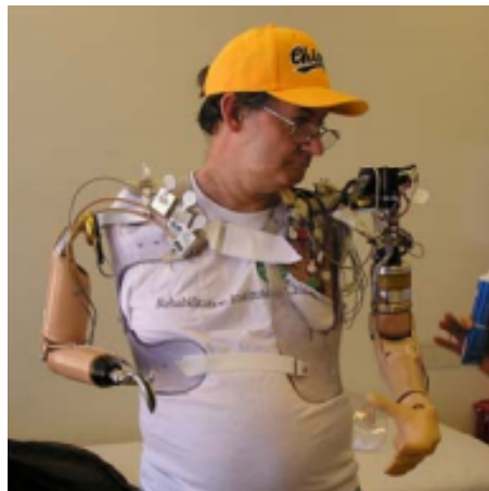
Figura 3: Prótesis de desarticulación de hombro (Weir, R. and Miller, L., 2014).
