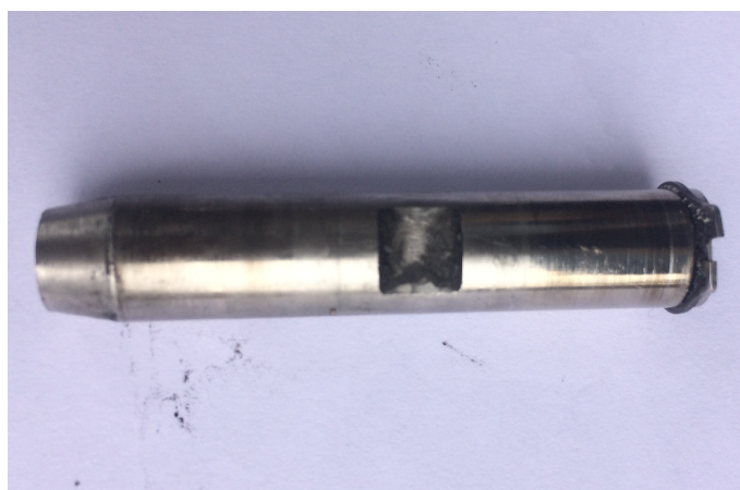
Figura 91: Eje metálico del tobillo.
