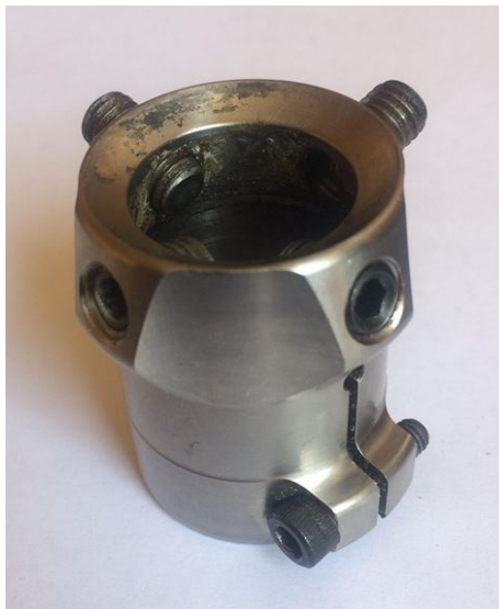
Figura 93: Adaptador tubular de titanio.
