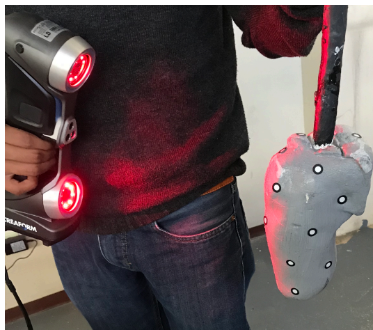
Figura 102: Escaneo del yeso
