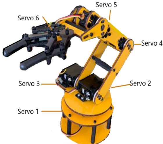
Fig. 11: Brazo robótico y posición de servomotores
