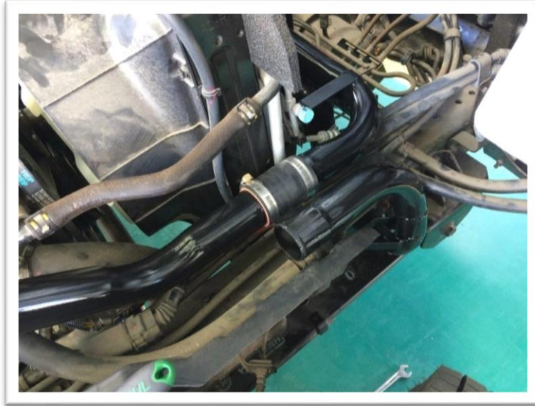
Ilustración 18 Cañerías del sistema de turbo fuente: Elaboracion propia
