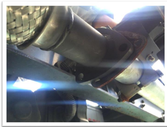
Ilustración 11 Desacople del sistema de escape: Elaboración propia
