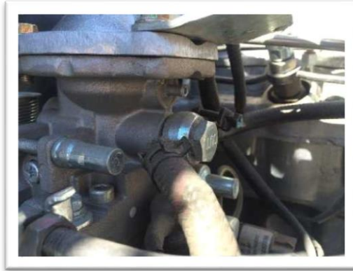
Ilustración 25 Manguera de flujo de aire y tornillo de regulación fuente: Elaboración propia
