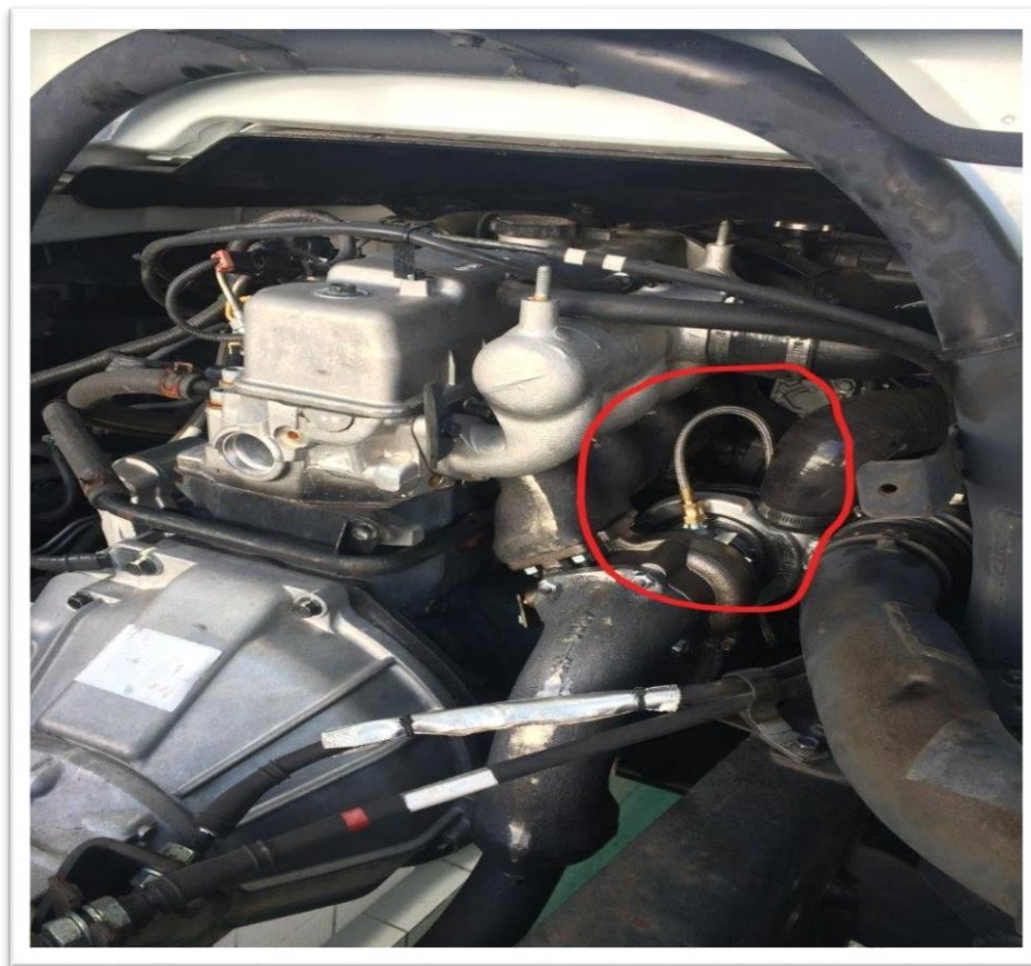
Ilustración 14 Mangueras de lubricación fuente: Elaboración propia
