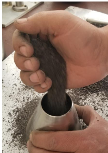
Figura 46. Colocación material fresado suelto en cilindro metálico– Ensayo determinación peso unitario
