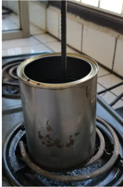
Figura 18. Calentamiento recipiente con emulsión asfáltica– Ensayo de residuo por evaporación
