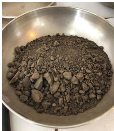
Figura 60. Material granular después de la extracción– Ensayo extracción asfalto residual
