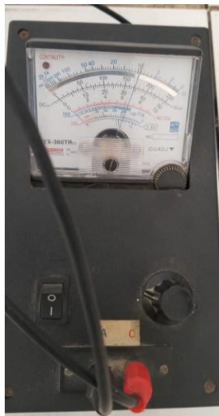
Figura 16. Adecuación de corriente en el potenciómetro – Ensayo identificación emulsión asfáltica por polaridad
