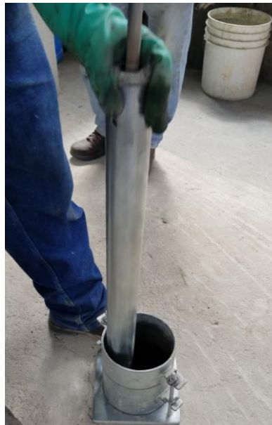
Figura 51. Apisonamiento de 56 golpes probeta– Ensayo Proctor modificado
