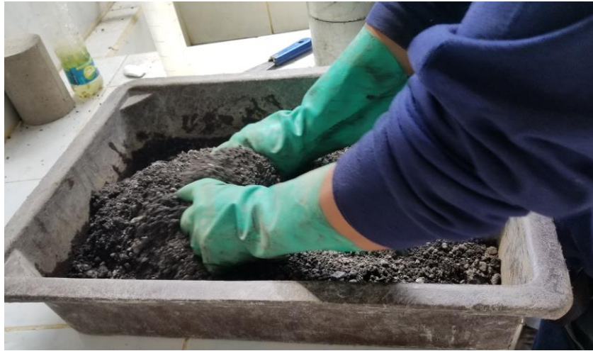
Figura 50. Mezcla con agua del material granular– Ensayo Proctor modificado
