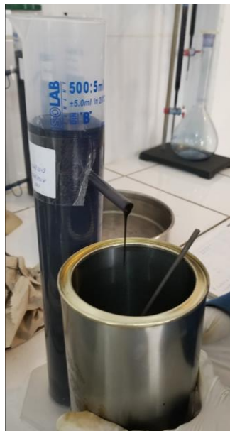
Figura 13. Exclusión emulsión asfáltica de la superficie – Ensayo estabilidad de almacenamiento
