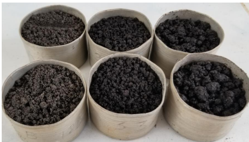
Figura 53. Muestra molde compactado – Ensayo Proctor modificado
