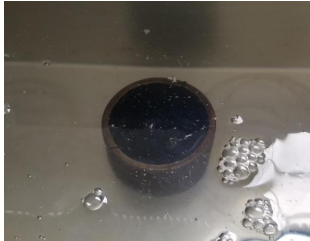
Figura 21. Residuo de emulsión asfáltica en baño de agua – Ensayo de penetración del residuo de emulsión asfáltica
