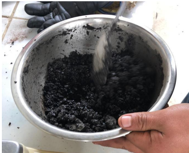
Figura 64. Mezcla de material fresado con emulsión asfáltica – Ensayo de estabilidad Marshall
