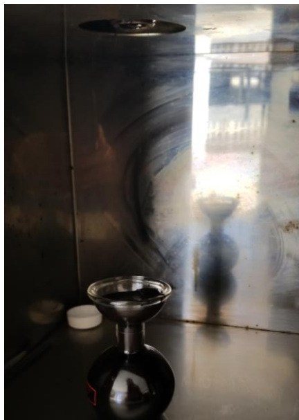
Figura 11. Emulsión asfáltica en copa receptora - Ensayo Viscosidad Furol a 25°C
