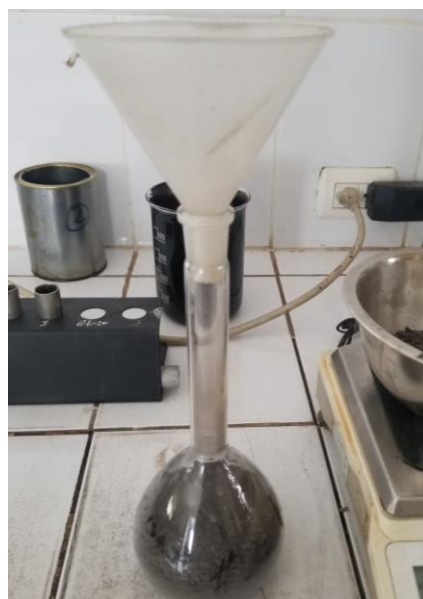
Figura 48. Picnómetro con material fino y agua– Ensayo determinación gravedad específica material fino
