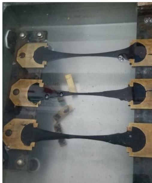
Figura 27. Proceso del ensayo – Ensayo de ductilidad del residuo de emulsión asfáltica
