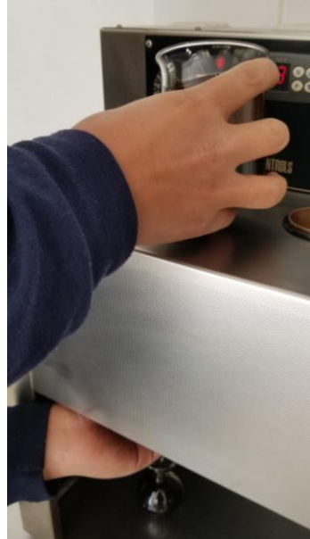
Figura 9. Emulsión asfáltica vertida en el viscosímetro – Ensayo Viscosidad Furol a 25°C
