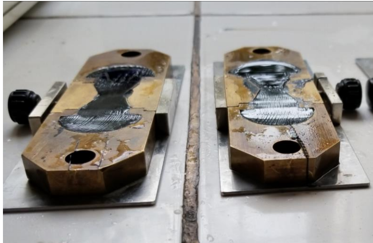
Figura 26. Residuo en molde enrasado – Ensayo de ductilidad del residuo de emulsión asfáltica
