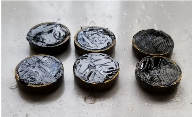
Figura 30. Enrasado de residuo en anillos – Ensayo de ductilidad del residuo de emulsión asfáltica
