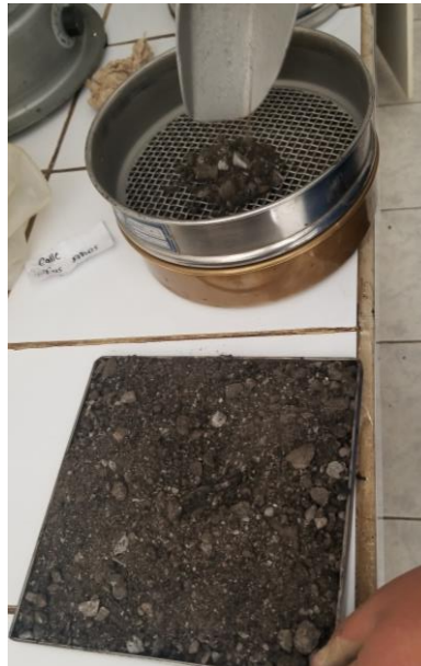
Figura 41. Separación fresado por el tamiz No. 4 – Ensayo equivalente de arena
