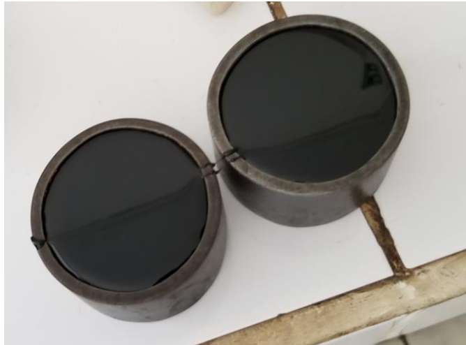
Figura 20. Residuo de emulsión asfáltica enfriándose en recipiente – Ensayo de penetración del residuo de emulsión asfáltica
