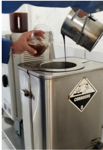
Figura 7. Colocación asfalto y emulsión asfáltica en molino coloidal.
