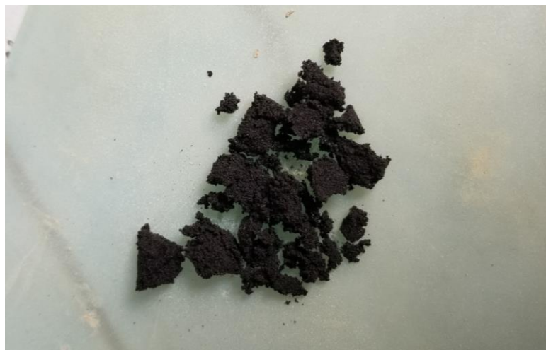
Figura 56. Resultado rollos de mezcla homogénea– Ensayo límite plástico
