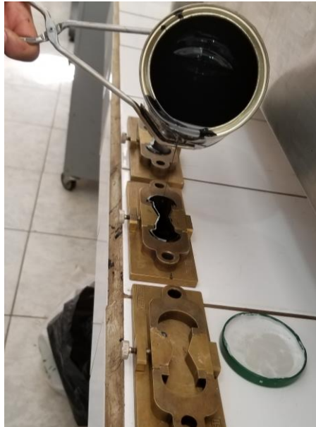
Figura 24. Colocación residuo en molde – Ensayo de ductilidad del residuo de emulsión asfáltica
