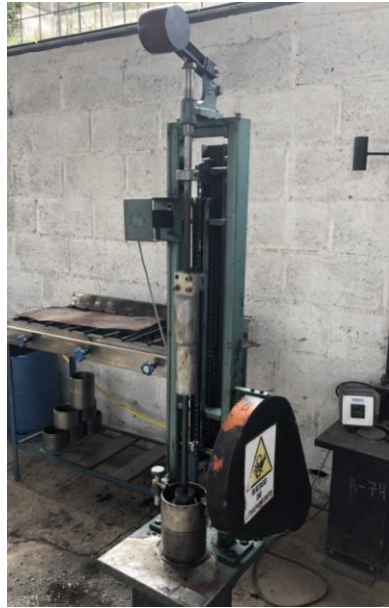
Figura 66. Compactación de las probetas – Ensayo de estabilidad Marshall
