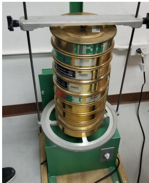
Figura 36. Proceso de tamizado – Ensayo granulometría por tamizado
