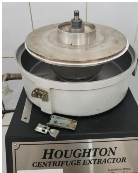
Figura 59. Armado de centrifugadora– Ensayo extracción asfalto residual
