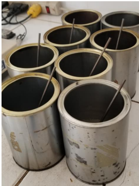
Figura 17. Pesaje recipientes con varilla– Ensayo de residuo por evaporación
