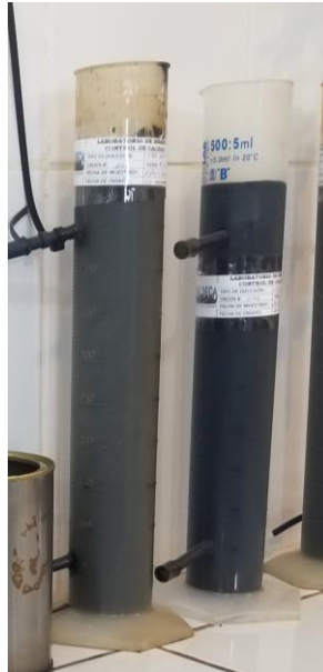
Figura 12. Emulsión asfáltica en reposo por 24 horas – Ensayo estabilidad de almacenamiento
