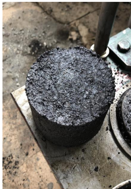
Figura 67. Resultado de compactación en briquetas – Ensayo de estabilidad Marshall
