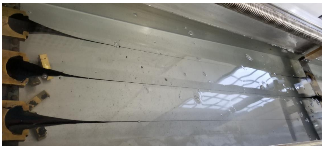
Figura 28. Resultados del ensayo – Ensayo de ductilidad del residuo de emulsión asfáltica
