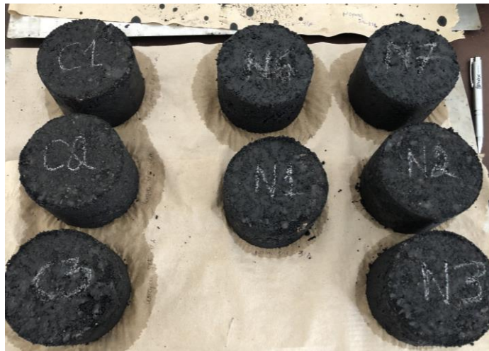
Figura 68. Enfriamiento de probetas – Ensayo de estabilidad Marshall
