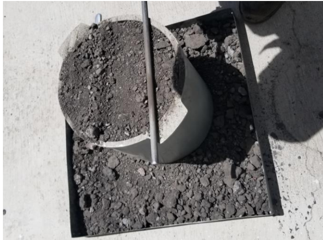
Figura 44. Enrasado en cilindro metálico después de ser compactado – Ensayo determinación peso unitario
