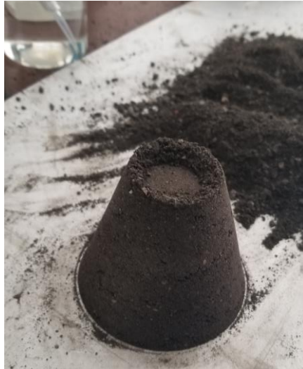
Figura 47. Forma cónica por levantamiento de cono– Ensayo determinación gravedad específica material fino
