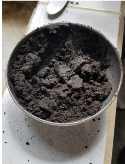
Figura 55. Mezcla homogénea con agua– Ensayo límite plástico
