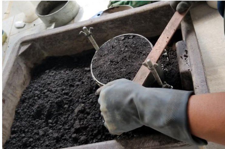
Figura 52. Enrasado de molde – Ensayo Proctor modificado
