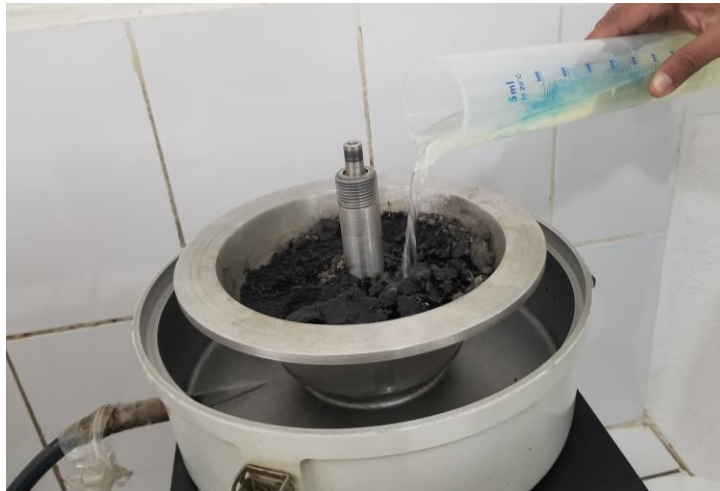
Figura 57. Colocación de químico en taza del equipo– Ensayo extracción asfalto residual
