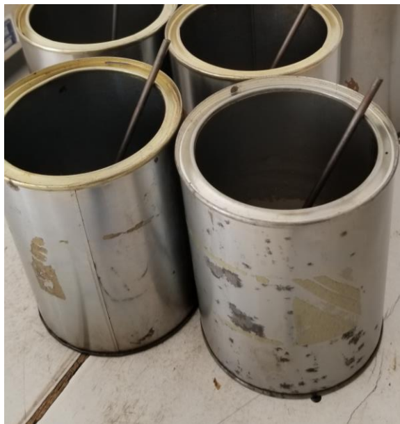
Figura 14. Enfriamiento residuo emulsión asfáltica – Ensayo estabilidad de almacenamiento
