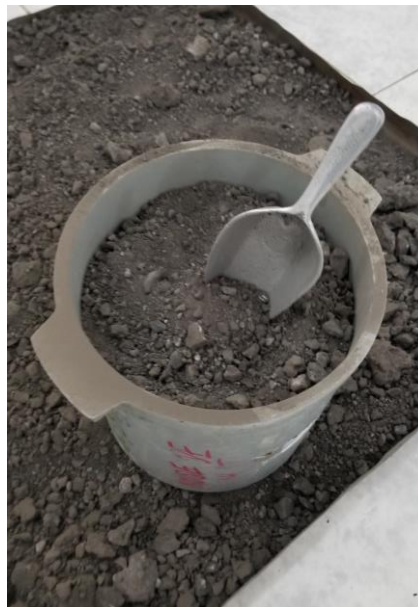
Figura 45. Colocación material fresado suelto en cilindro metálico– Ensayo determinación peso unitario
