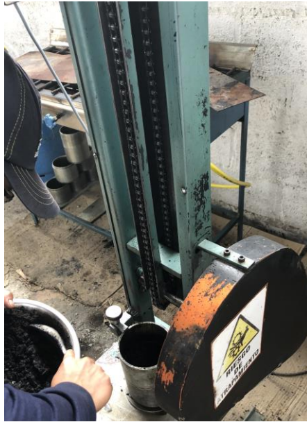
Figura 65. Armado del conjunto de compactación – Ensayo de estabilidad Marshall
