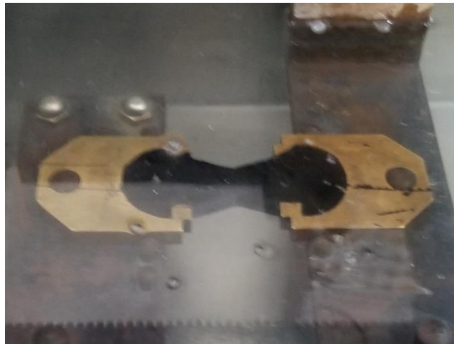
Figura 25. Baño en agua del residuo en molde – Ensayo de ductilidad del residuo de emulsión asfáltica
