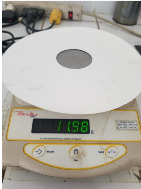
Figura 58. Pesaje papel filtro– Ensayo extracción asfalto residual
