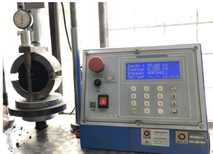
Figura 70. Colocación probeta en equipo Marshall– Ensayo de estabilidad Marshall
