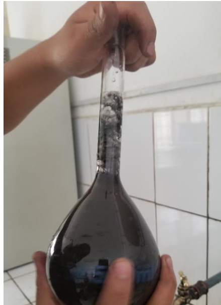
Figura 49. Eliminación de aire del picnómetro– Ensayo determinación gravedad específica material fino
