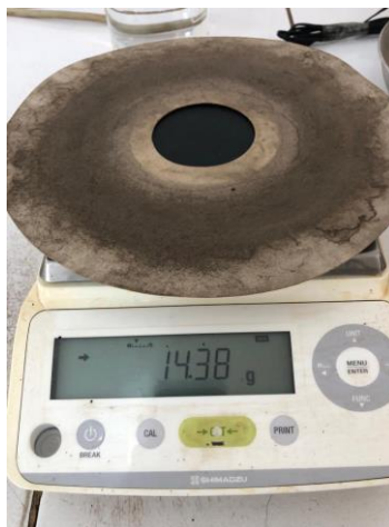
Figura 61. Pesaje papel filtro después de la extracción– Ensayo extracción asfalto residual
