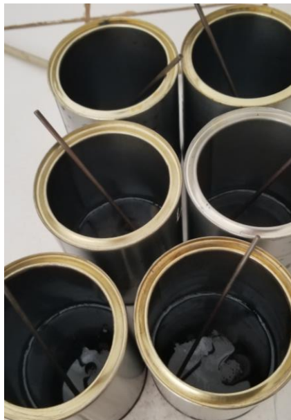
Figura 19. Residuo de emulsión asfáltica– Ensayo de residuo por evaporación
