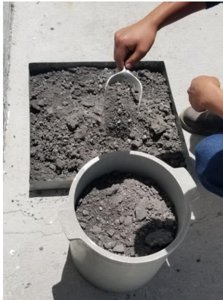
Figura 43. Colocación material en cilindro metálico en 3 capas– Ensayo determinación peso unitario
