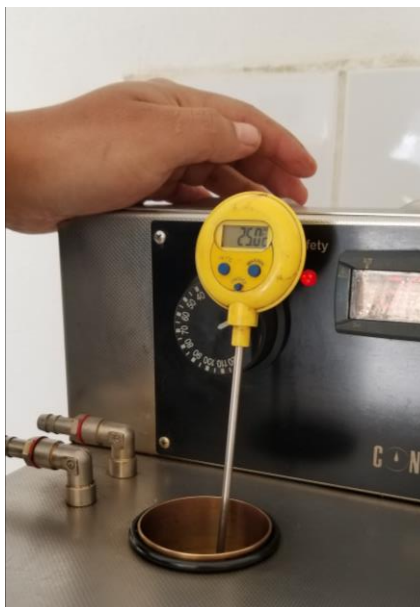
Figura 10. Temperatura constante emulsión asfáltica - Ensayo Viscosidad Furol a 25°C
