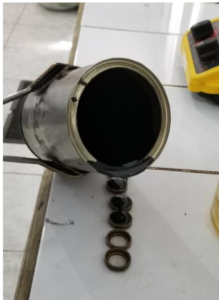
Figura 29. Colocación residuo emulsión asfáltica en anillos – Ensayo de ductilidad del residuo de emulsión asfáltica
