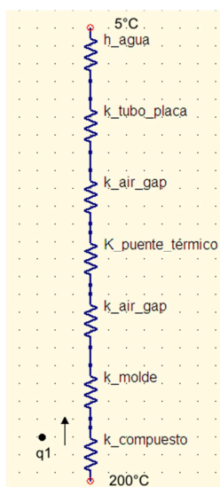
Figura 3.4. Circuito térmico de la parte superior del modelo 2.
