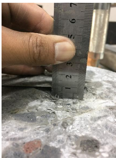
Fotografía 4: 1 [cm] de Abrasión como Parámetro de Falla en Hormigón con Fibras
