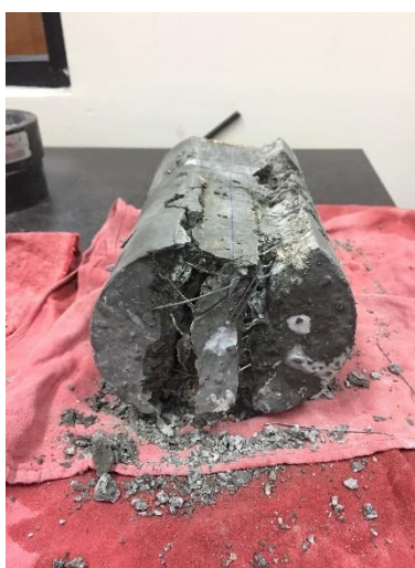
Fotografía 3: Falla dúctil con evidencia de fenómeno Pullout
