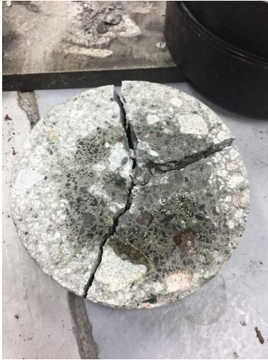
Fotografía 13: Ensayo a Impacto Hormigón Tradicional
