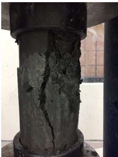
Fotografía 18: Hormigón con Partículas de Caucho Falla Tipo Columnar ASTM C39
