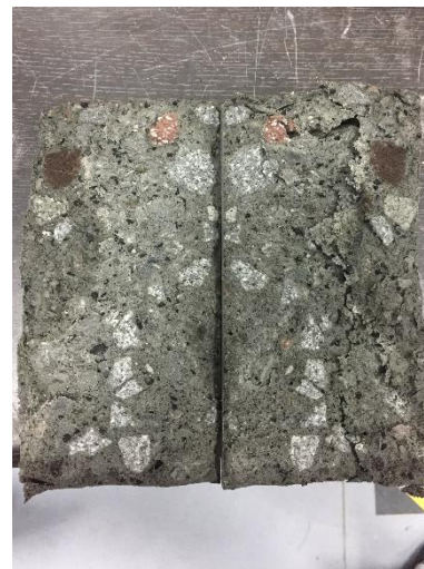
Fotografía 23: Hormigón Tradicional Ensayado a Tensión 15% Caucho
