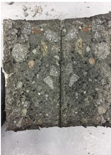
Fotografía 21: Hormigón Tradicional Ensayado a Tensión 0% Caucho
