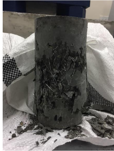
Fotografía 7: Hormigón Reforzado con Fibras Falla Tipo 4. ASTM C39
