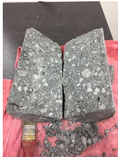
Fotografía 12: Falla Dúctil Hormigón Tradicional
