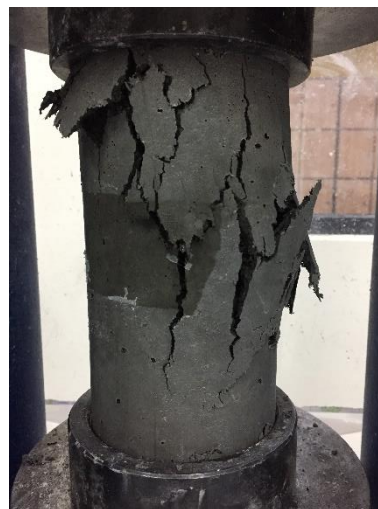
Fotografía 20: Hormigón con Partículas de Caucho Falla Tipo 3 ASTM C39
