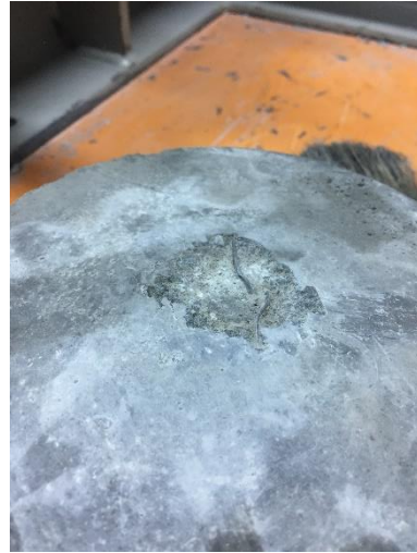
Fotografía 15: Abrasión en Hormigón con Fibras Ensayo a Impacto
