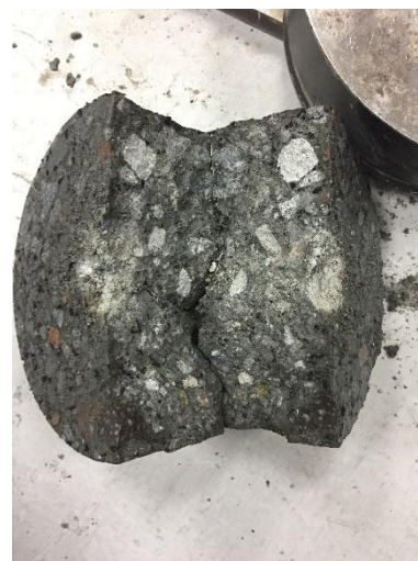
Fotografía 26: Hormigón con %Caucho Ensayado Falla: Rotura
