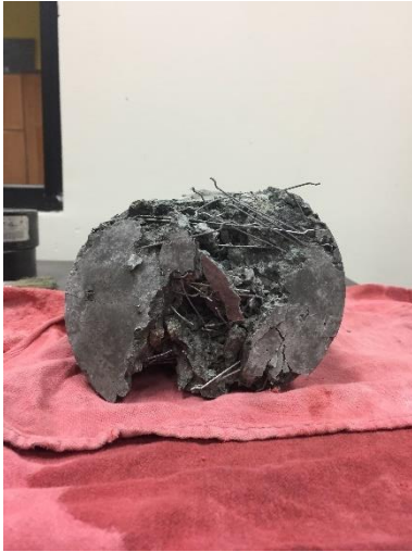
Fotografía 9: Falla Dúctil Hormigón Reforzado con Fibras
