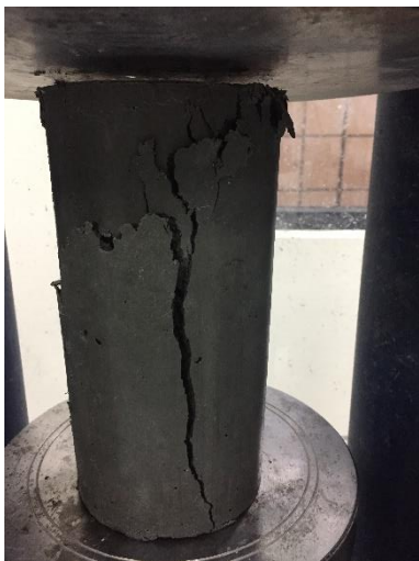
Fotografía 17: Hormigón con Partículas de Caucho Falla Tipo Columnar ASTM C39
