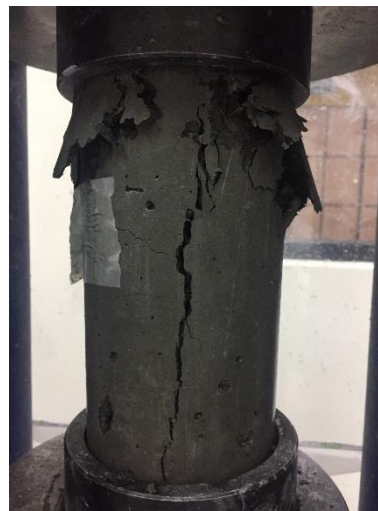
Fotografía 19: Hormigón con Partículas de Caucho Falla Tipo Columnar ASTM C39
