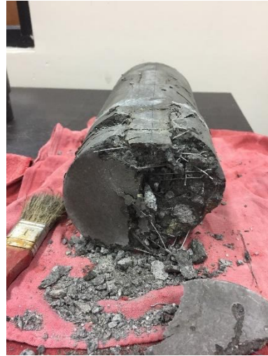
Fotografía 11: Falla Dúctil Hormigón Reforzado con Fibras
