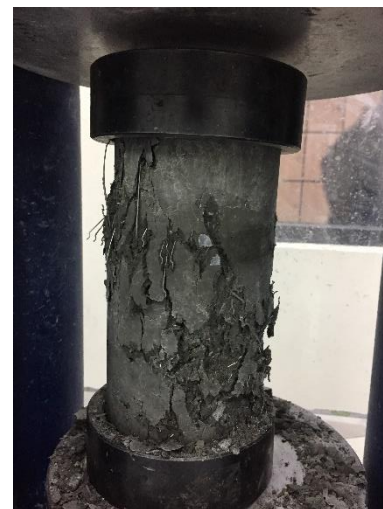
Fotografía 8: Hormigón Reforzado con Fibras Falla Tipo 4. ASTM C39
