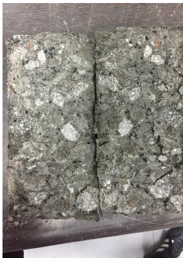
Fotografía 22: Hormigón Tradicional Ensayado a Tensión 7% Caucho
