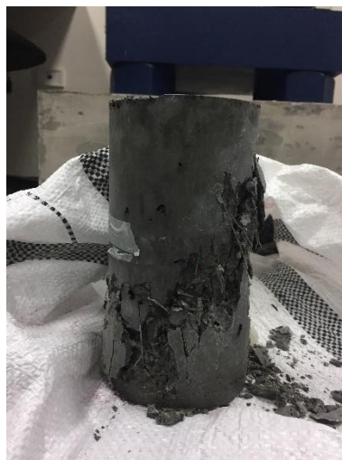
Fotografía 6: Hormigón Reforzado con Fibras Falla Tipo 4. ASTM C39
