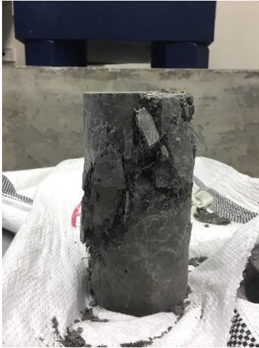
Fotografía 5: Hormigón Reforzado con Fibras Falla Tipo 4. ASTM C39
