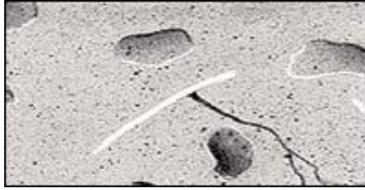
Fotografía 1: Control de Fisuras por Medio de Fibras. Fuente: EMB Construcción
