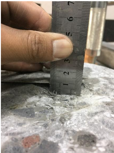
Fotografía 14: 1 [cm] de Abrasión como Parámetro de Falla en Hormigón con Fibras
