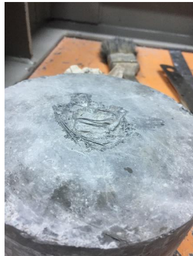
Fotografía 16: Abrasión en Hormigón con Fibras Ensayo a Impacto
