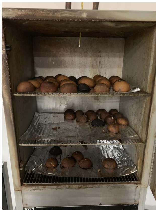
Imagen 8. Secado de baterías en horno
