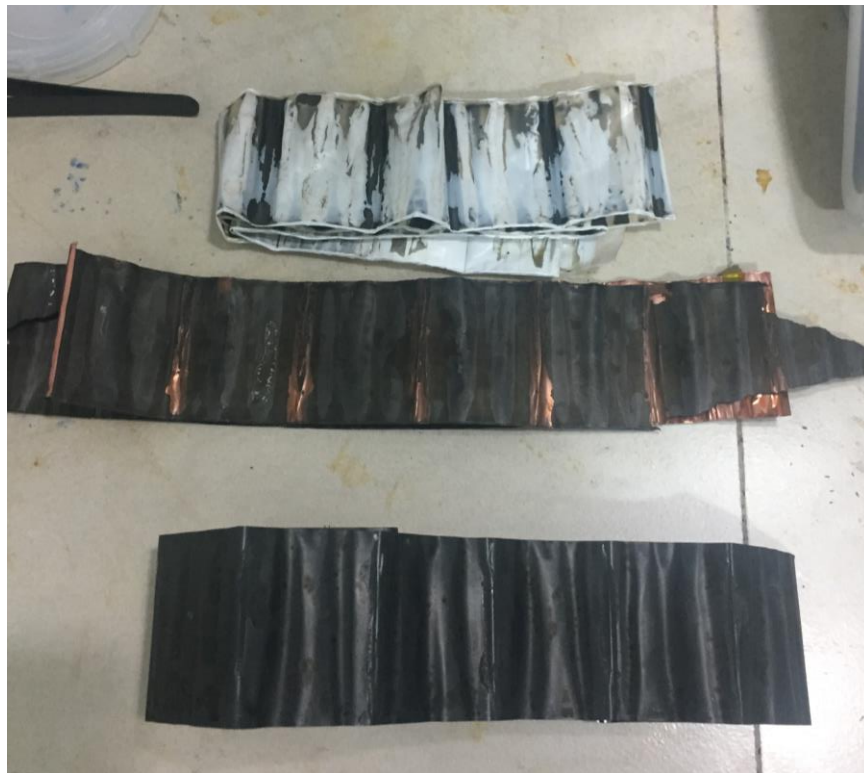
Imagen 3. Proceso de desmantelamiento manual de la batería de ion litio. En la parte superior el separador, en la mitad el ánodo de cobre y debajo el cátodo de aluminio cubierto con el material activo ( \text{LiCoO}_2 )
