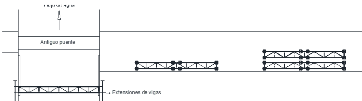
Figura No. 91. Movimiento del pórtico conforme se mueven las vigas metálicas y se las embancan
