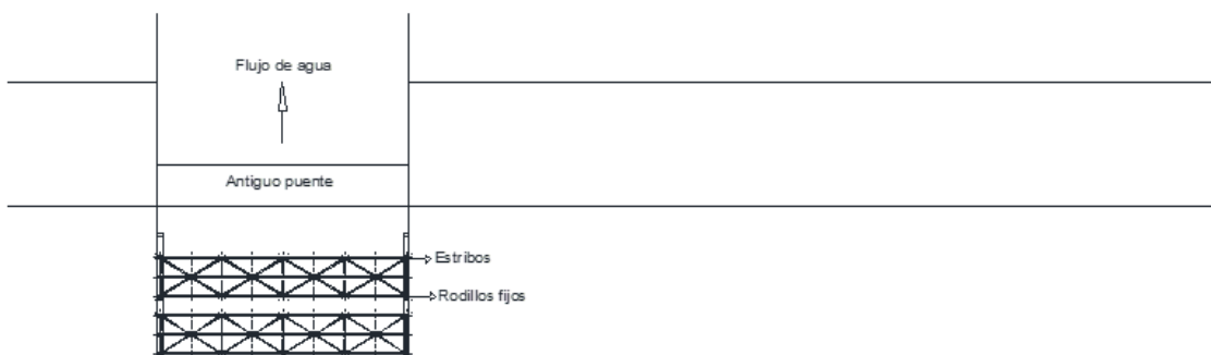
Figura No. 86. Vigas ubicadas aguas arriba del puente existente
