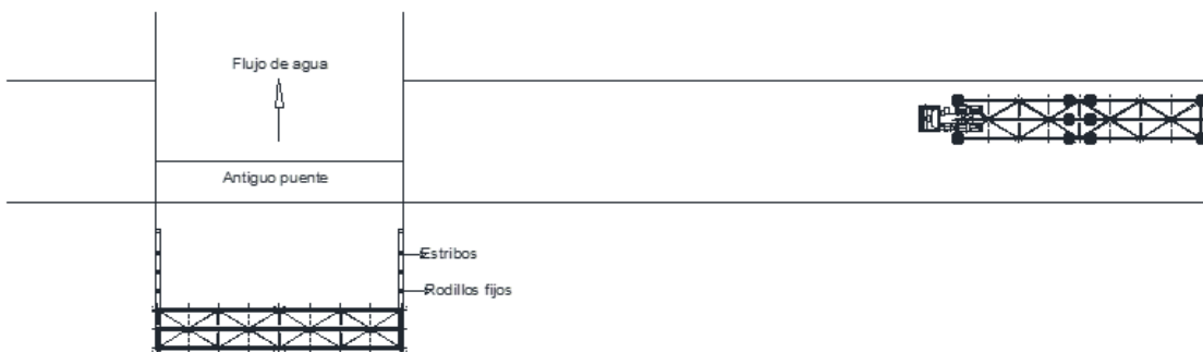
Figura No. 84: Segundo trío de vigas metálicas lista para ser movidas a través del puente
