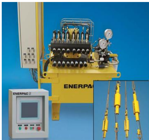
Figura No. 58: Cilindros hidráulicos para alinear longitudinal y transversalmente las vigas metálicas
