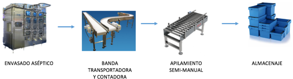
Figura 3. Diagrama del proceso de clasificación semiautomática de leche en funda. Adaptado de los bocetos técnicos presentados en el Anexo E.
