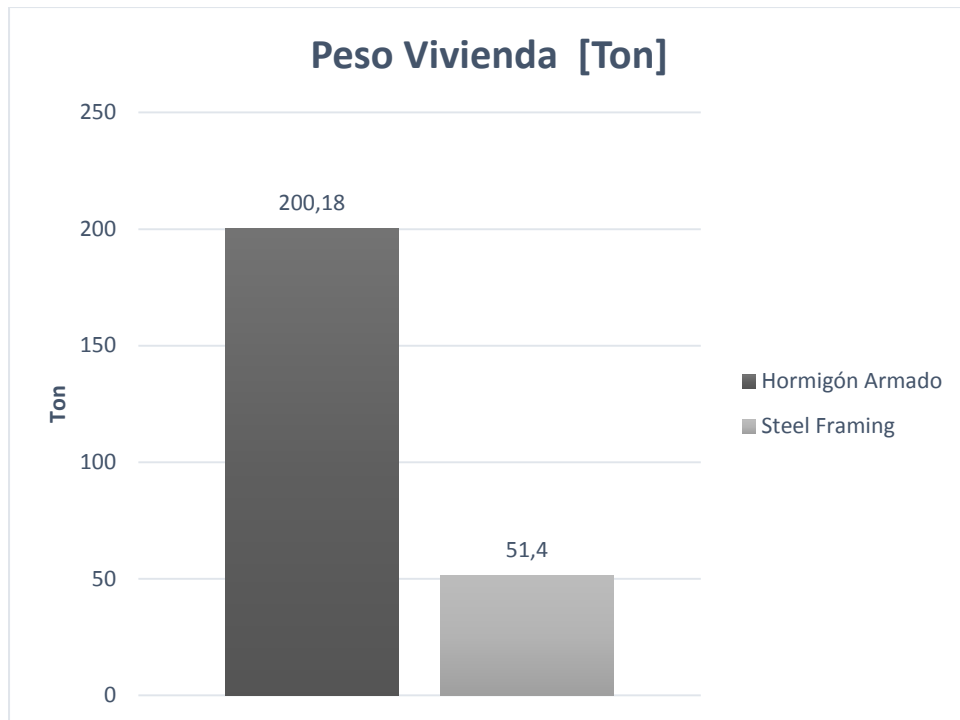
Ilustración 77. Comparación de Pesos de los Sistemas Constructivos
