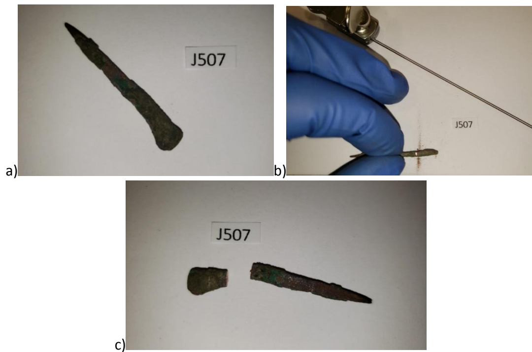
Figura 6: Procedimiento para toma de muestra. a) muestra J507. b) corte transversal de la muestra. c) artefacto cortado.
