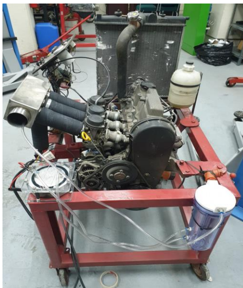
Figura 9. Conexión del depósito de electrolito con la celda generadora de HHO.
