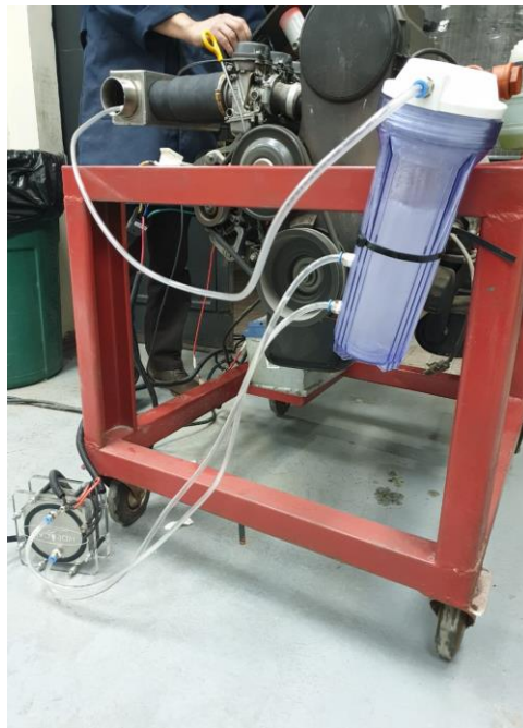
Figura 8. Ubicación en el motor maqueta del Sistema Generador de HHO Fuente: Elaboración propia
